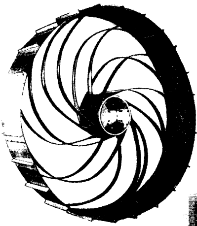
Рис. 4.4. Колесо со спицами в виде ленточных пружин
