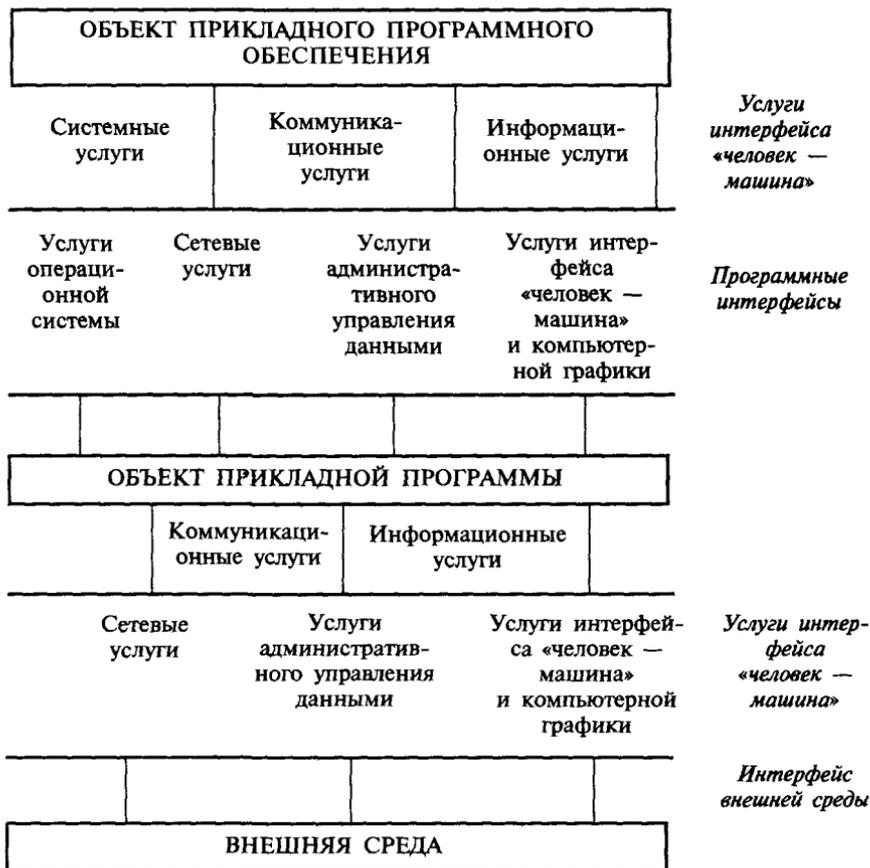
Рис. 2.1. Эталонная модель функционирования среды открытых систем
