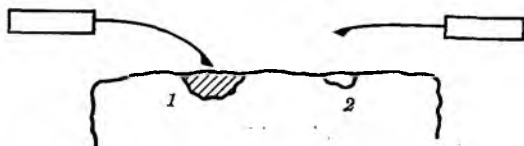
Рис. 39. Устройство магнитного указателя и положение его над магнитным (1) и немагнитным (2) минералами
