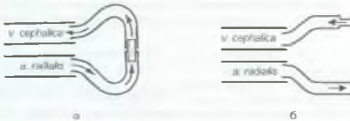
Рис. 9-5. Установка и работа артериовенозного шунта вне гемодиализа (а) и во время него (б)
