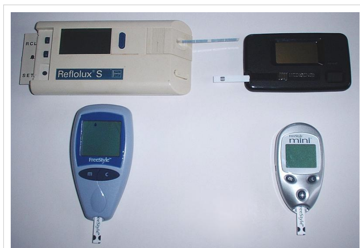
Эволюция портативных экспресс-анализаторов уровня глюкозы в крови (глюкометров) 1993 — 2005 гг. Измерение проводится с помощью тест-полосок и цветовой шкалы. Изначально время теста достигало двух минут. Современные приборы выдают приемлемый результат в течение 5 секунд.
