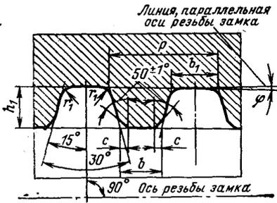
Предельные отклонения замковой резьбы должны быть следующими:
