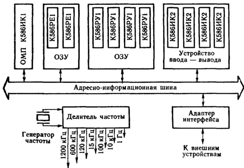
Рис 23. Структурная схема микроЭВМ «Электроника С5-21».
