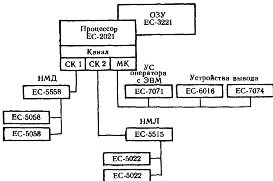
Рис. 5. Структурная схема ЭВМ ЕС-1021.
