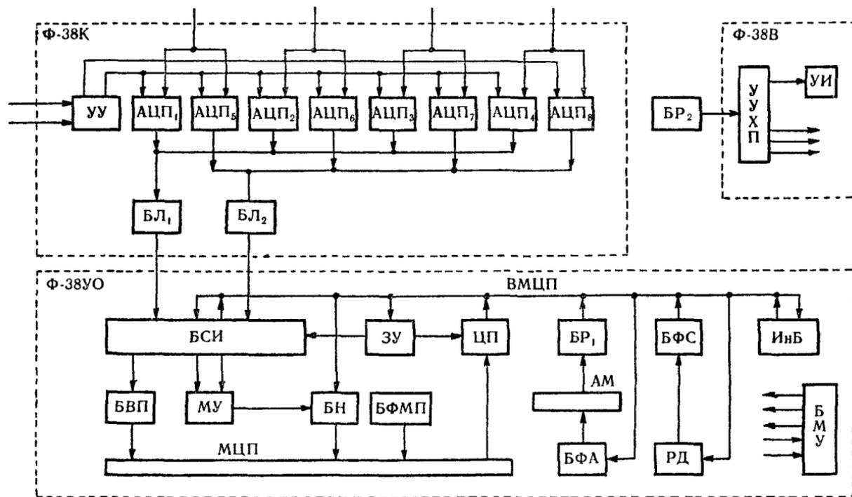
Рис. 44. Структурная схема Φ-38:
