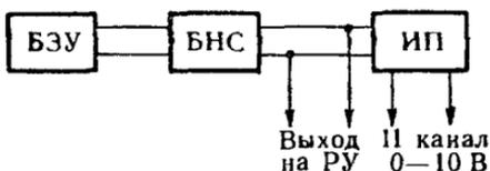
нормализации сигналов БН. Усиленный сигнал разбаланса поступает на измерительный прибор (ИП) А-542, а также на регулирующее устройство (РУ), подключаемое к установке (регулирующее устройство в состав установки не входит). При работе
