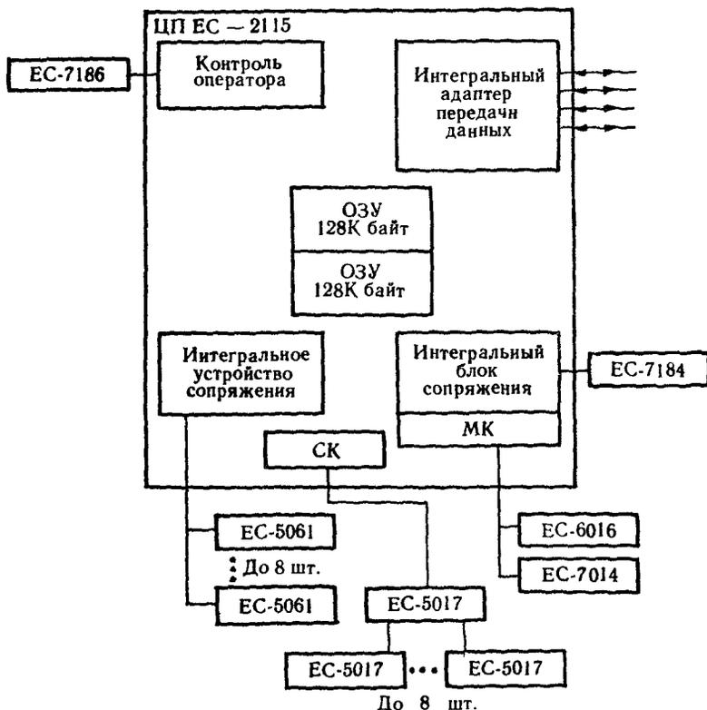
Рис. 3. Структурная схема ЭВМ ЕС-1015.
