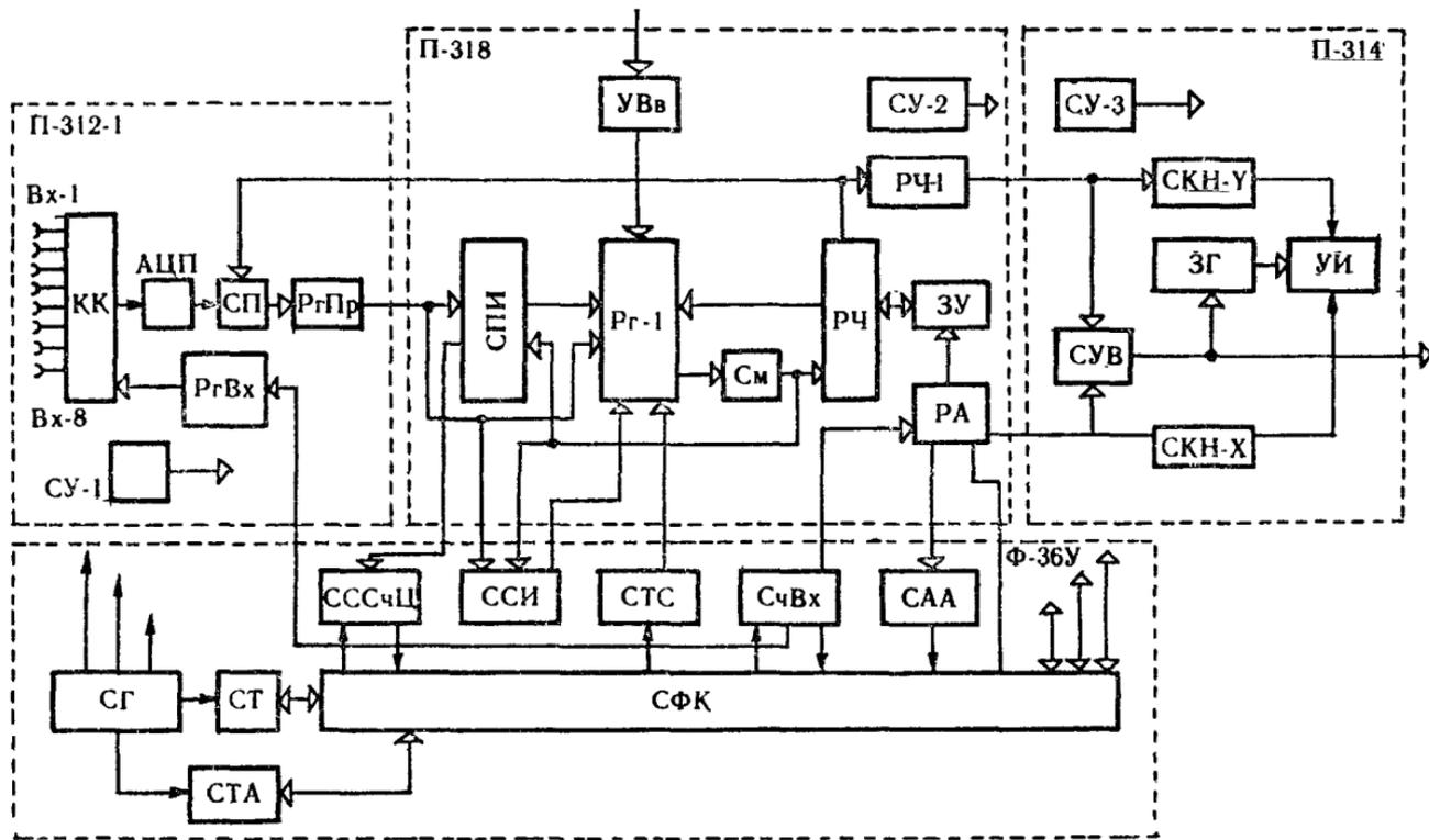
Рис. 43. Структурная схема  $\Phi$ -36:
