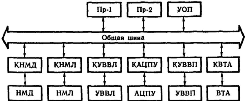
Рис. 16. Структурная схема ВК СМ-1600:
