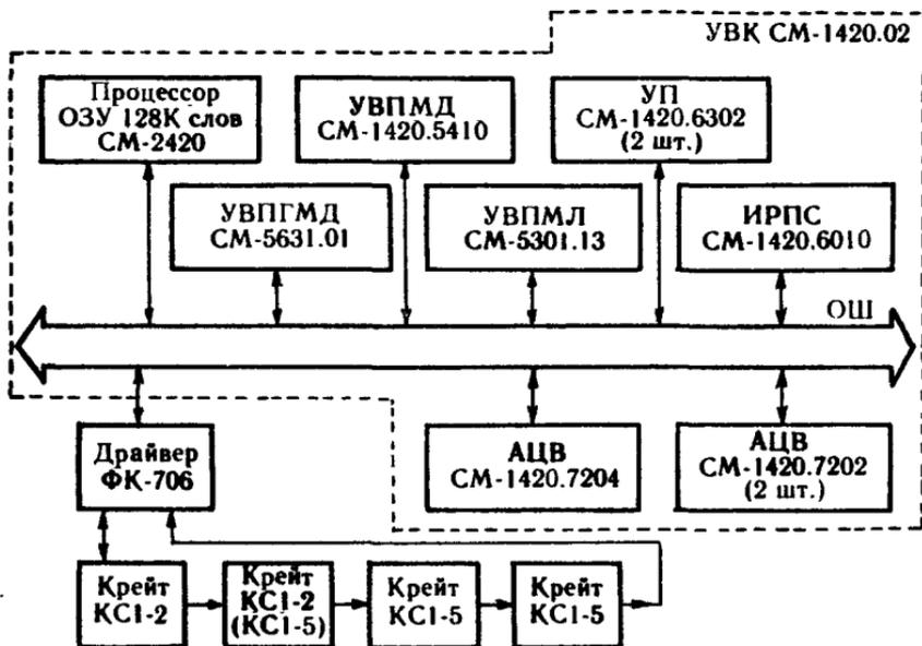
Рис. 36. Структурная схема ИВК-10-1, ИВК-10-2.
