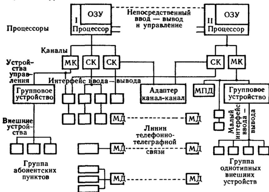
Рис. 1. Структурная схема технических средств ЕС ЭВМ:
