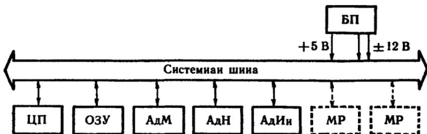
Рис. 20. Структурная схема базовой модели ПП ЭВМ ЕС-1840:
