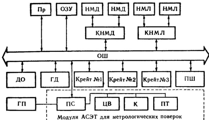
Рис. 33. Структурная схема ИВК-4:
