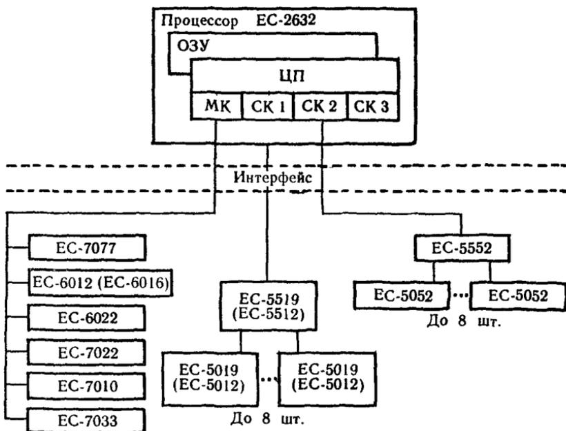
Рис. 7. Структурная схема ЭВМ ЕС-1032.
