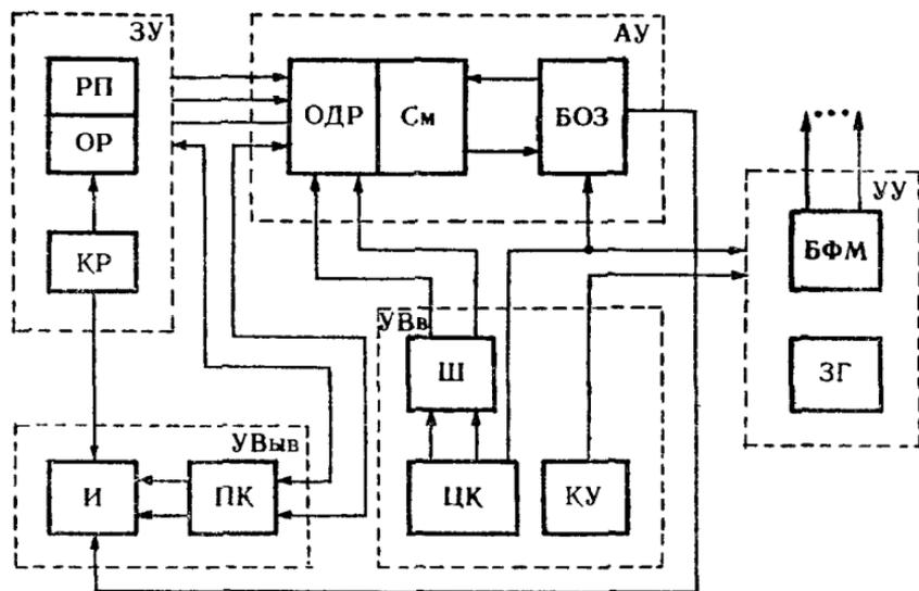
Рис. 24. Типовая структурная схема ЭКВМ:
