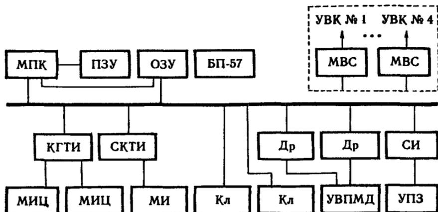
Рис 17. Структурная схема терминала РМОТ-02 максимальной конфигурации:
