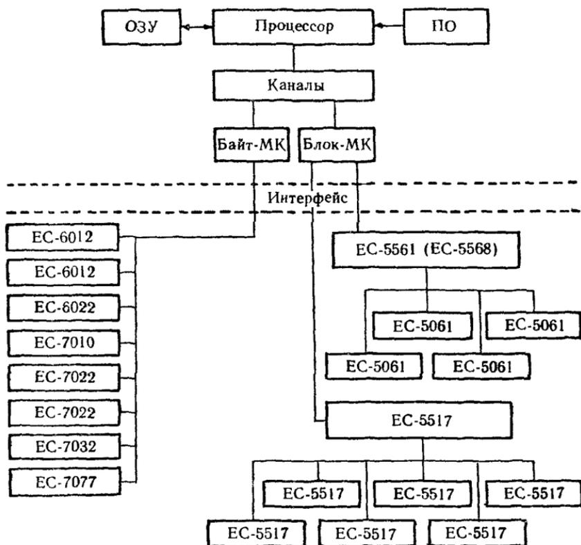
Рис. 11. Структурная схема ЭВМ ЕС-1045.
