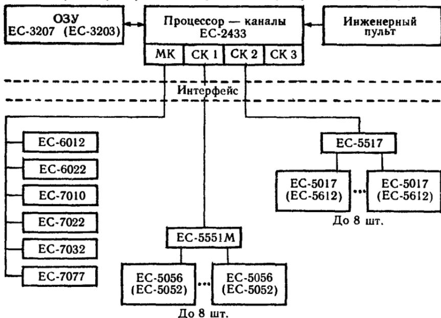
Рис. 8. Структурная схема ЭВМ ЕС-1033.
