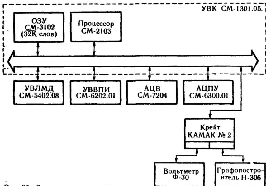
Рис. 32. Структурная схема ИВК-3.
