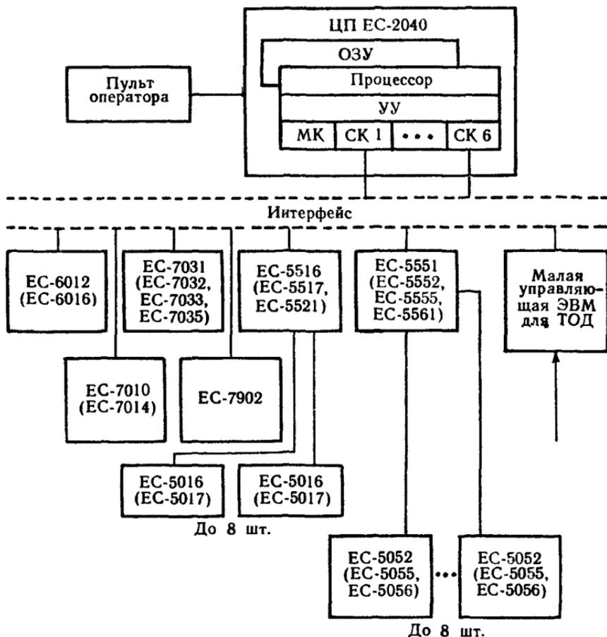
Рис. 10. Структурная схема ЭВМ ЕС-1040.
