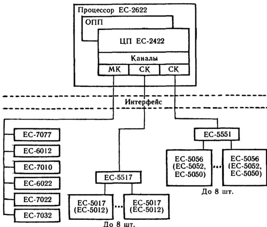
Рис. 6. Структурная схема ЭВМ ЕС-1022.
