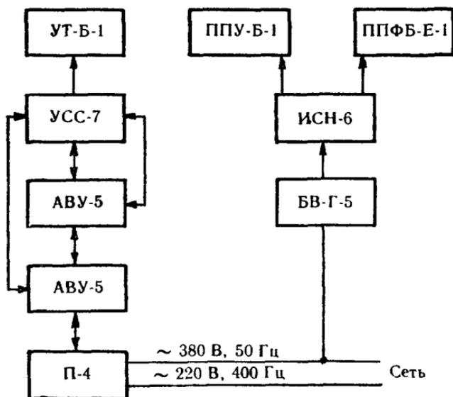
Рис. 48. Структурная схема типового набора комплекса АВК-2(3):
