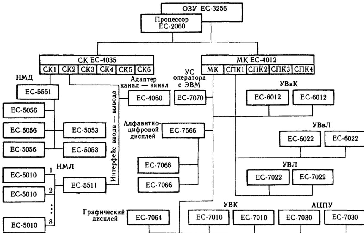
Рис. 13. Структурная схема ЭВМ ЕС-1060.
