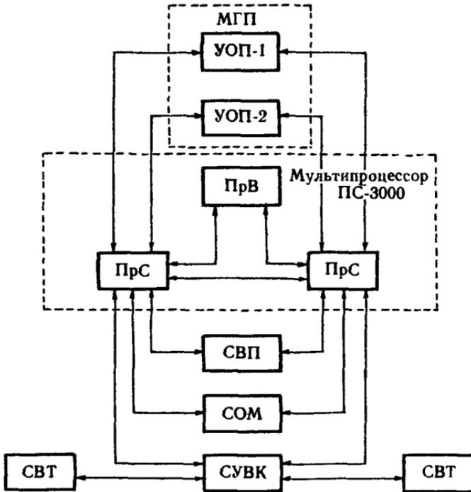
Рис. 18. Структурная схема РГВК К143-12:
