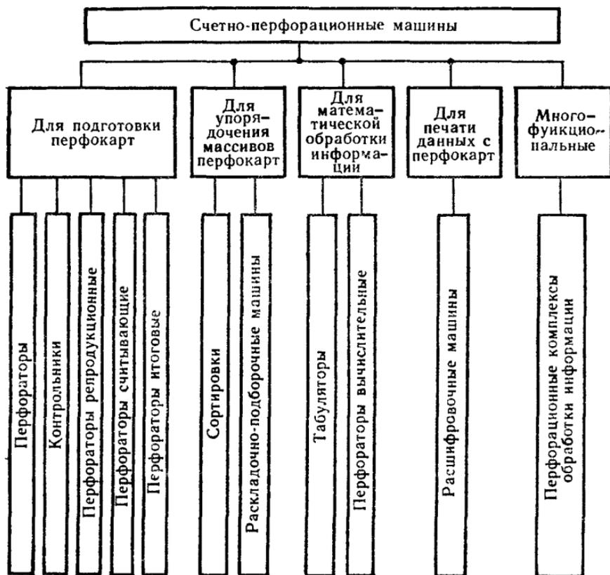
Рис. 45. Схема классификации счетно-перфорационных машин.
