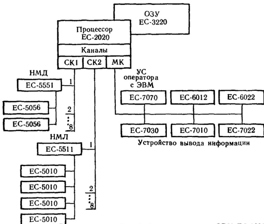
Рис. 4. Структурная схема ЭВМ ЕС-1020.
