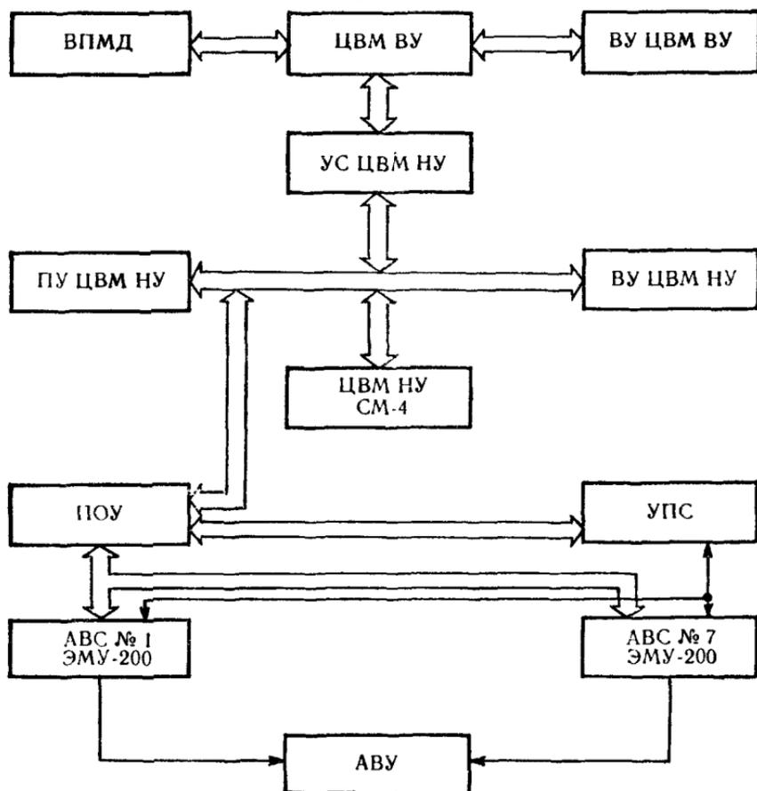
Рис. 56. Структурная схема цифровой части АЦВС «Русалка»:
