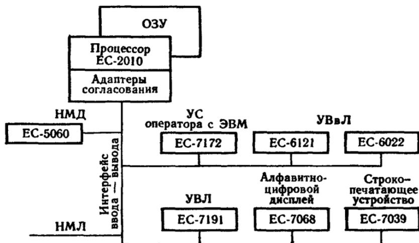
Рис. 2. Структурная схема ЭВМ ЕС-1010.
