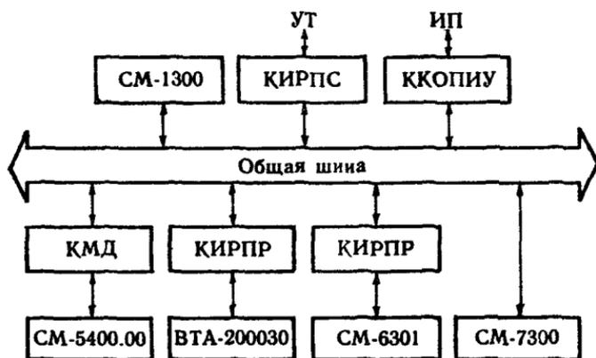
Рис. 14. Структурная схема УВК СМ-1300.1701.02.
