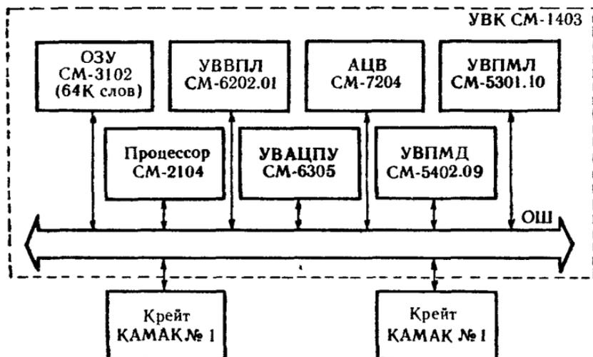
Рис. 31. Структурная схема ИВК-2.
