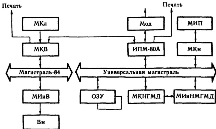
Рис. 19. Структурная схема ПЭВМ ВЭФ МИКРО 1025РС:
