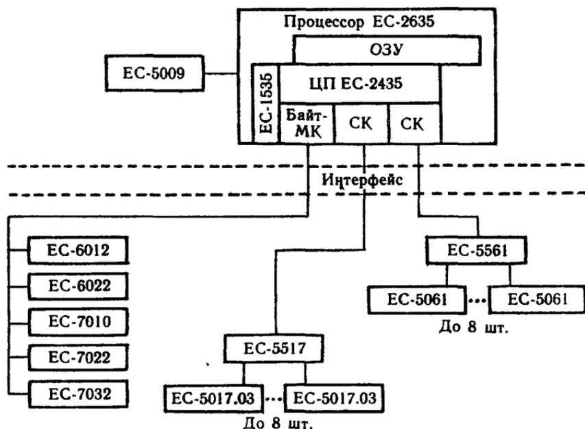
Рис. 9. Структурная схема ЭВМ ЕС-1035.
