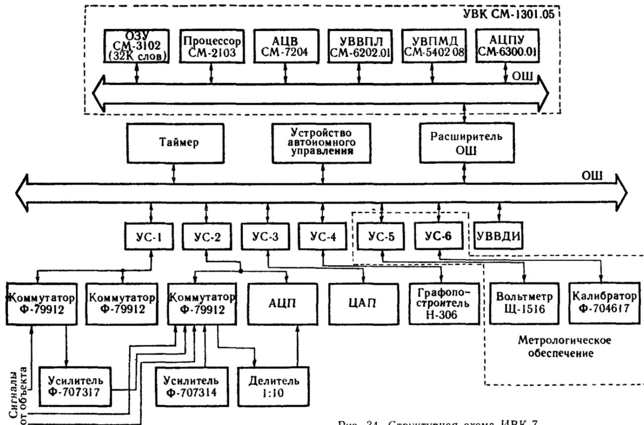
Рис. 34. Структурная схема ИВК-7
