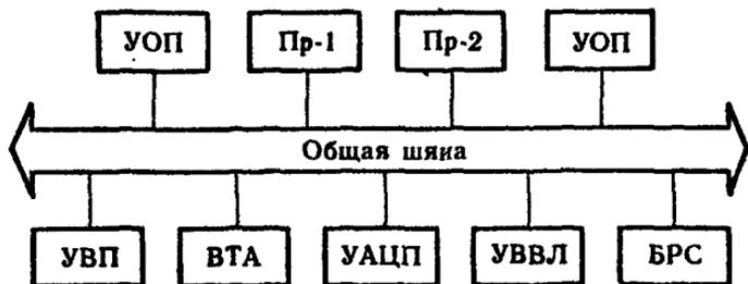
Рис. 15. Структурная схема УВК СМ-1410.
