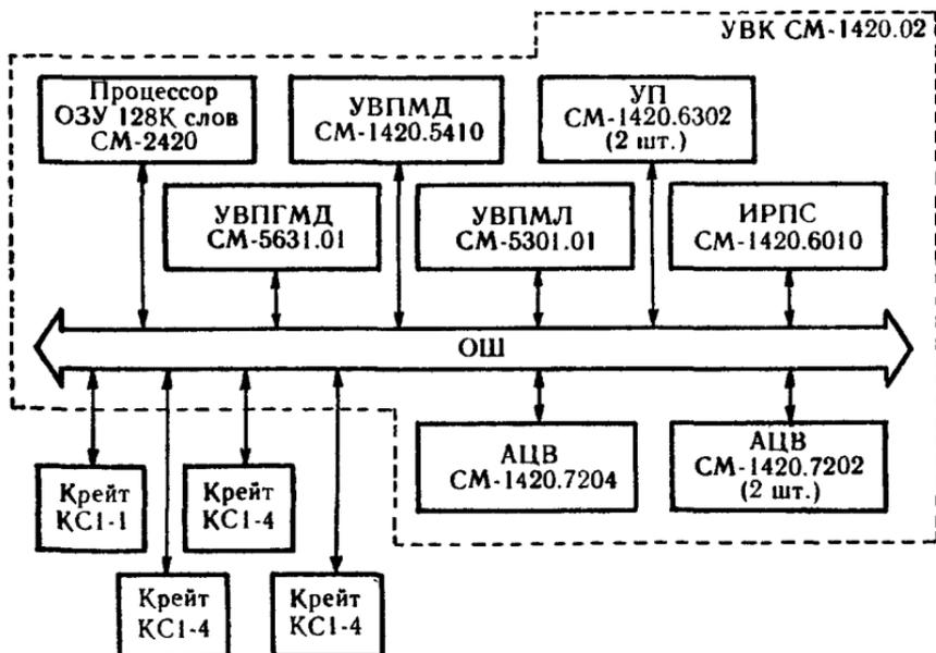
Рис. 37. Структурная схема ИВК-10-03.
