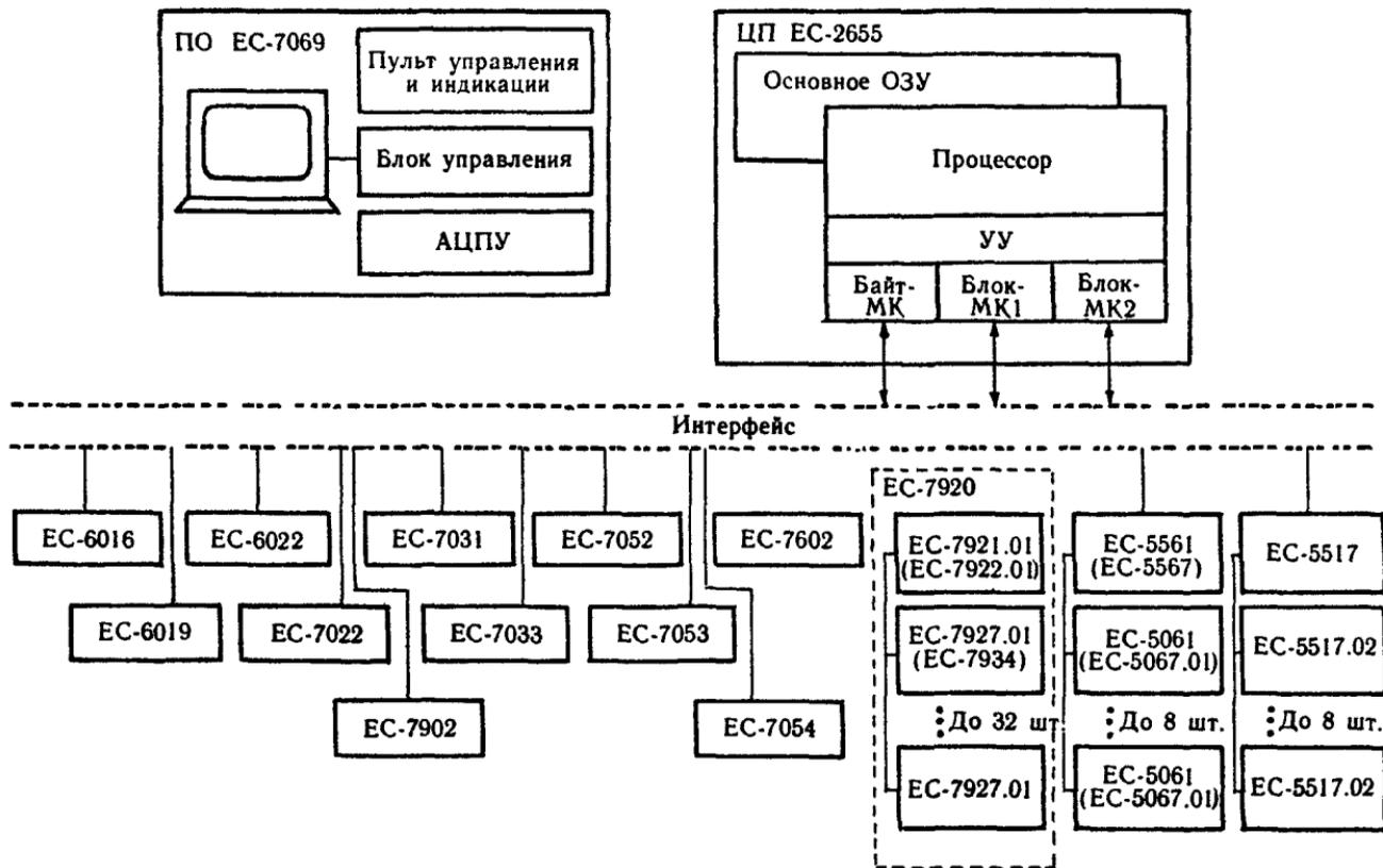
Рис. 12. Структурная схема ЭВМ ЕС-1055.
