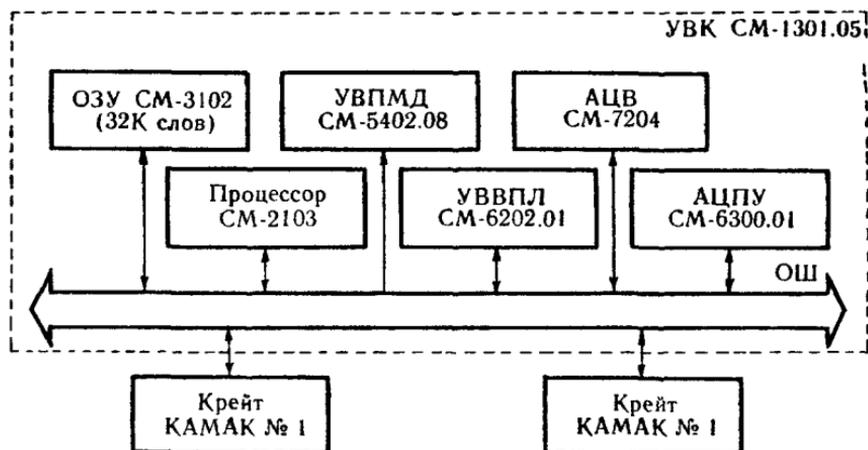
Рис. 30. Структурная схема ИВК-1.
