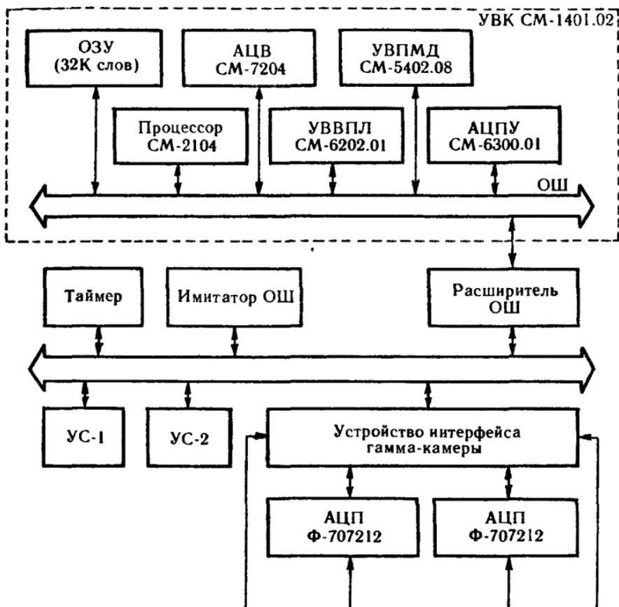
Рис. 39. Структурная схема ИВК «Гамма».
