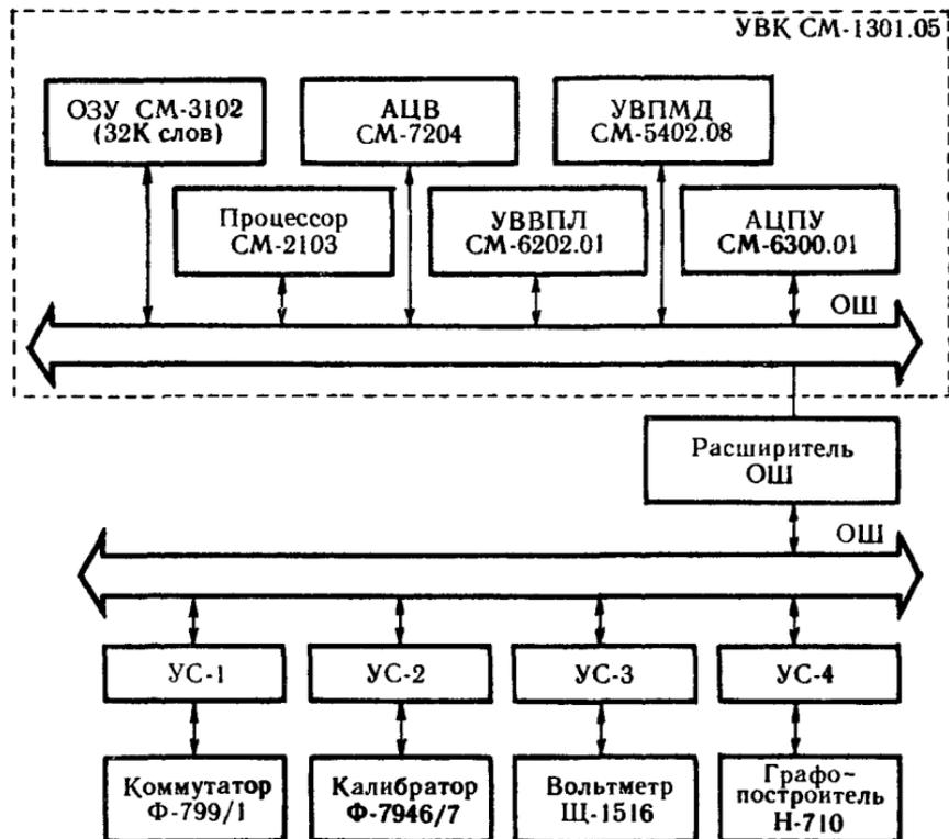
Рис. 35. Структурная схема ИВК-8.
