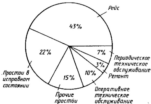
Рис. 1. Диаграмма распределения фонда времени самолетного парка по состояниям эксплуатации
