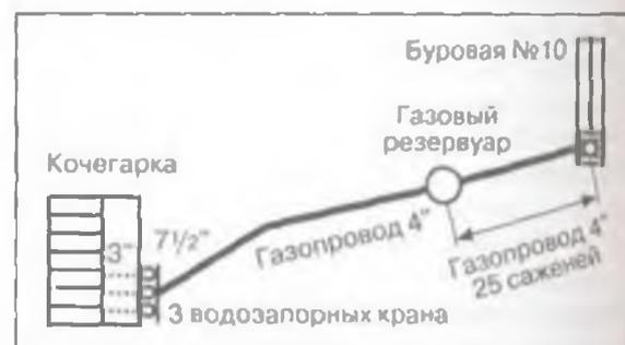
Рис. 3. Схема добычи газа из скважины № 10/11 в районе Грозненского месторождения.
