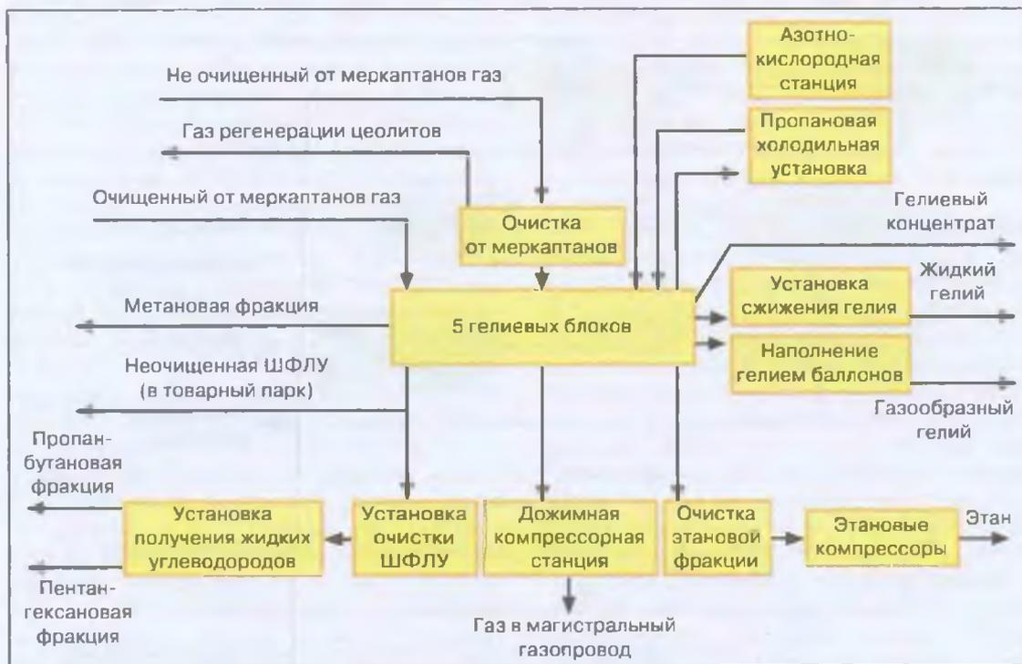
Рис. 1. Блок-схема Оренбургского гелиевого завода.
