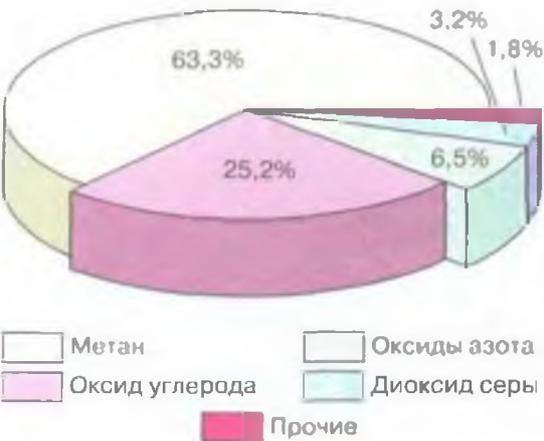
Рис. 2. Структура выбросов загрязняющих веществ в атмосферу в газовой промышленности.
