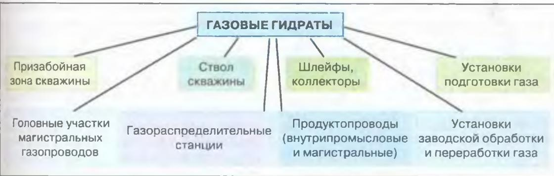
Рис. 1. Газопромысловые системы с возможным техногенным гидратообразованием.
