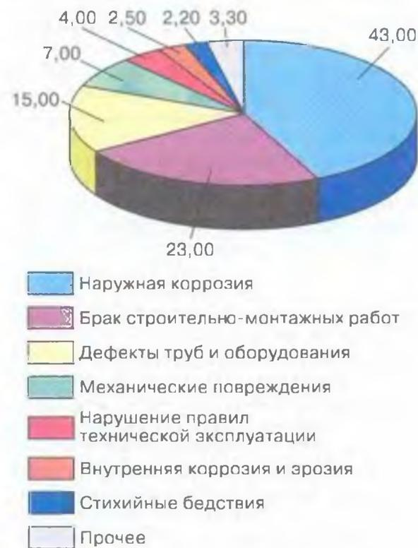
Рис. 1. Анализ причин аварий линейной части магистральных газопроводов за период эксплуатации с 1968 по 1991 (%).
