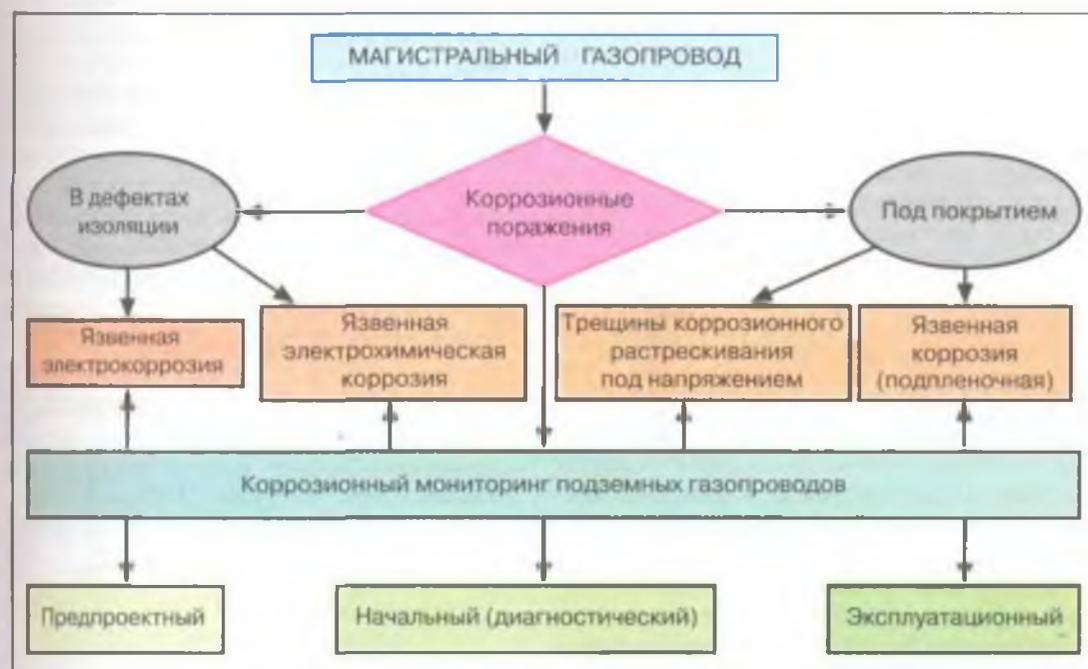
Рис. 3. Классификация систем коррозионного мониторинга магистрального газопровода по фазам реализации и видам коррозионных поражений.
