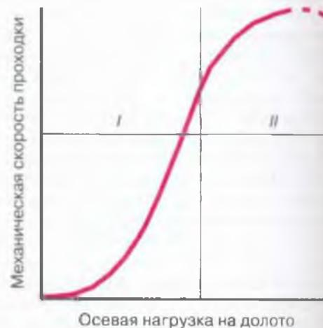
Рис. 1. Влияние осевой нагрузки на механическую скорость проходки.
