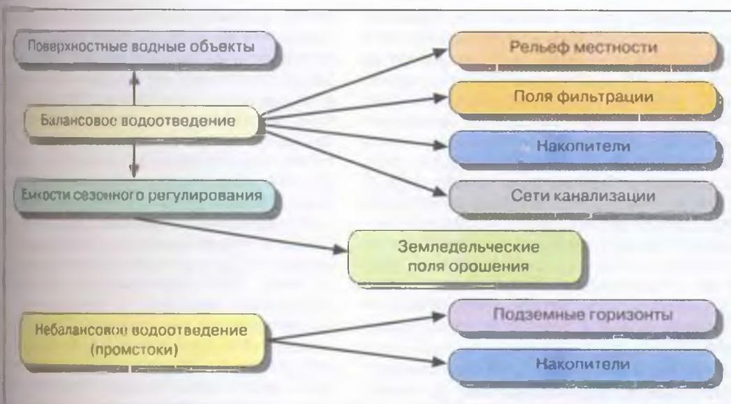
Структура водоотведения по видам сточных вод в газовой отрасли.
