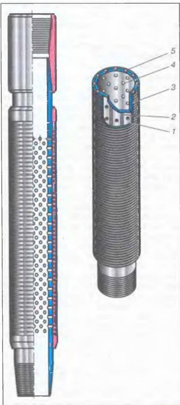
Рис. 2. Конструкция фильтра ФСК: 1 — труба-каркас; 2 — опорный стержень; 3 — профилированная проволока; 4 — перфорационные отверстия; 5 — контактная сварка.
