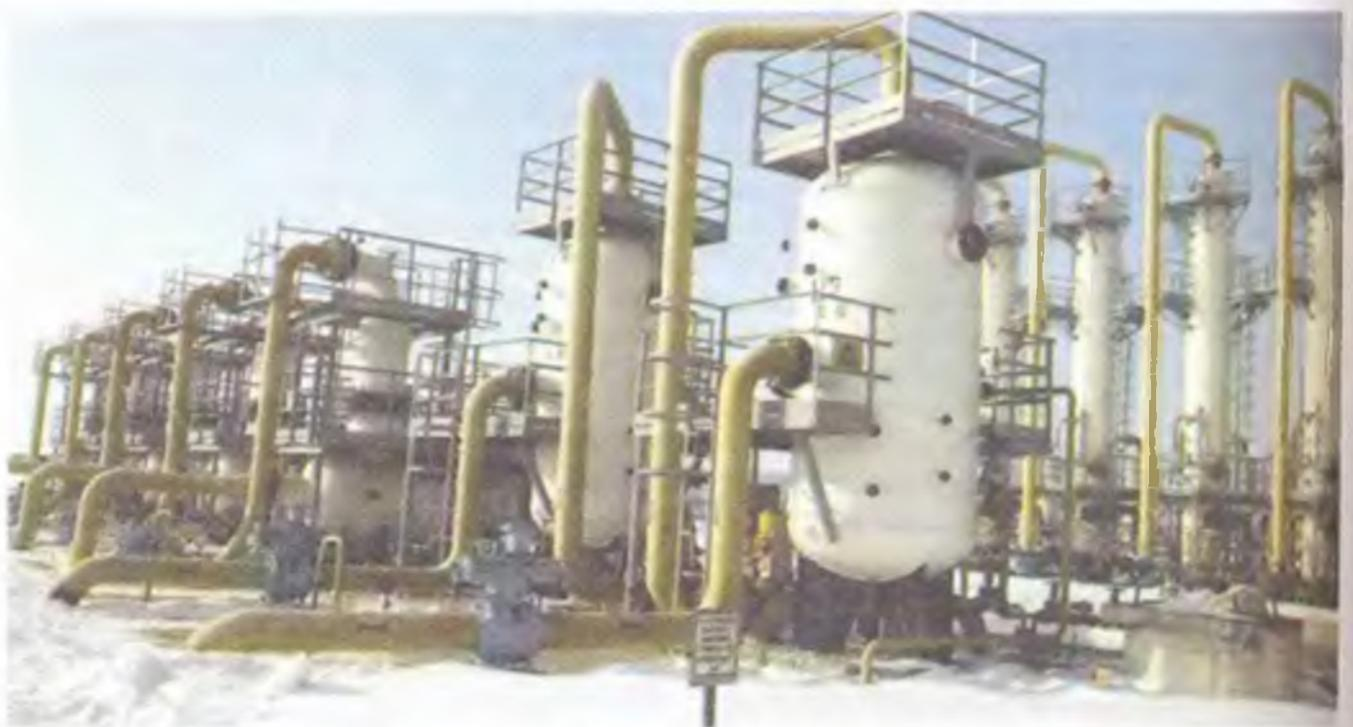
Сепаратор блока подготовки газа к транспорту.
