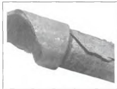
Рис. 3. Сероводородное растрескивание трубы на одной из скважин Оренбургского месторождения.
