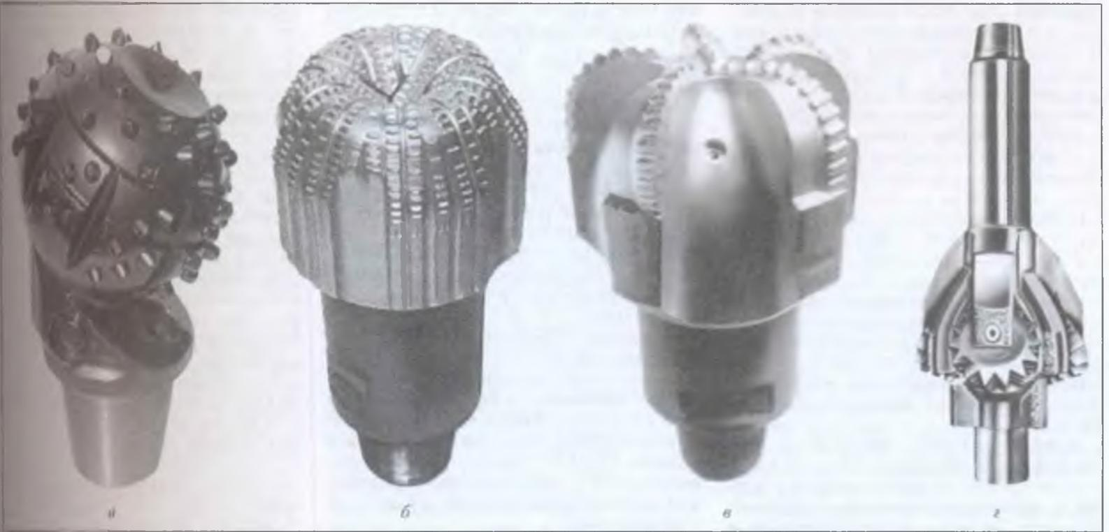
Рис. 1 Породоразрушающий инструмент: а – одношарошечное буровое долото с герметизированной опорой шарошки; б – алмазное буровое долото; в – буровое долото с резами PDC; г – стандартный шарошечный расширитель.
