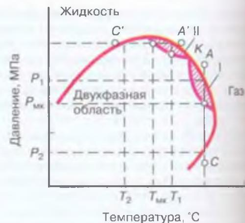
Фазовая диаграмма многокомпонентной углеводородной системы: *K* – критическая точка многокомпонентной системы; *I* – область ретроградной конденсации; *II* – область ретроградного испарения.
