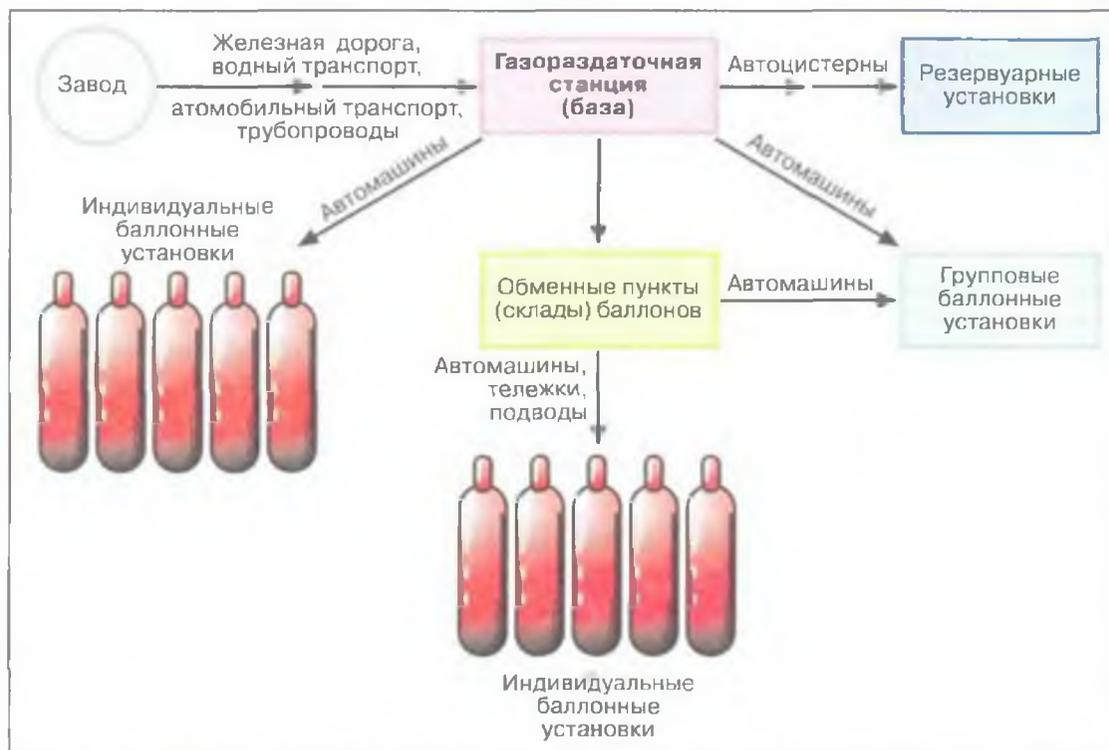
Рис. 1. Схема организации снабжения сжиженным газом.
