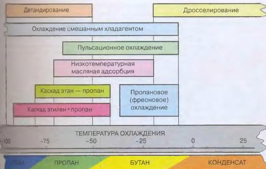
Рис. 1. Диаграмма для предварительного выбора процесса охлаждения газа.
