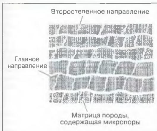
Рис. 1 Схематическое изображение системы трещин породы.
