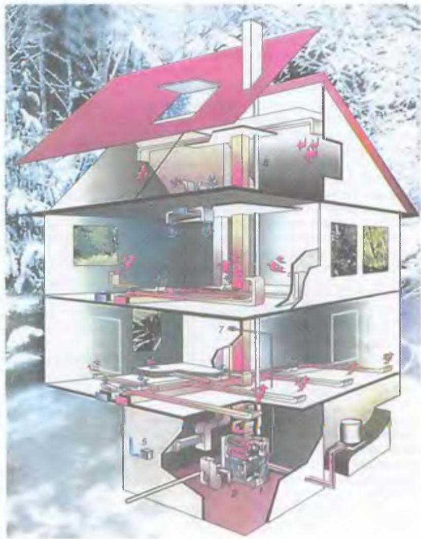
Рис. 7. Воздушное отопление дома: 1 – газовый воздухонагреватель; 2, 4 – фильтр; 3 – охладитель кондиционера; 5 – забор свежего воздуха; 6 – компрессор кондиционера; 7 – термостат; 8 – дымоход.
