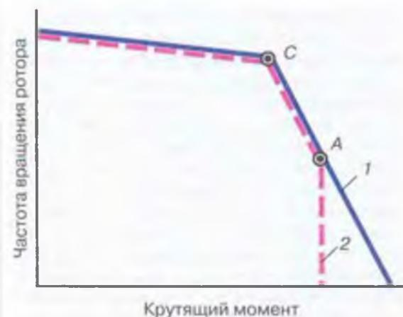
Механические характеристики электропривода постоянного тока для ротора: 1 — режим максимального момента; 2 — режим минимального момента.
