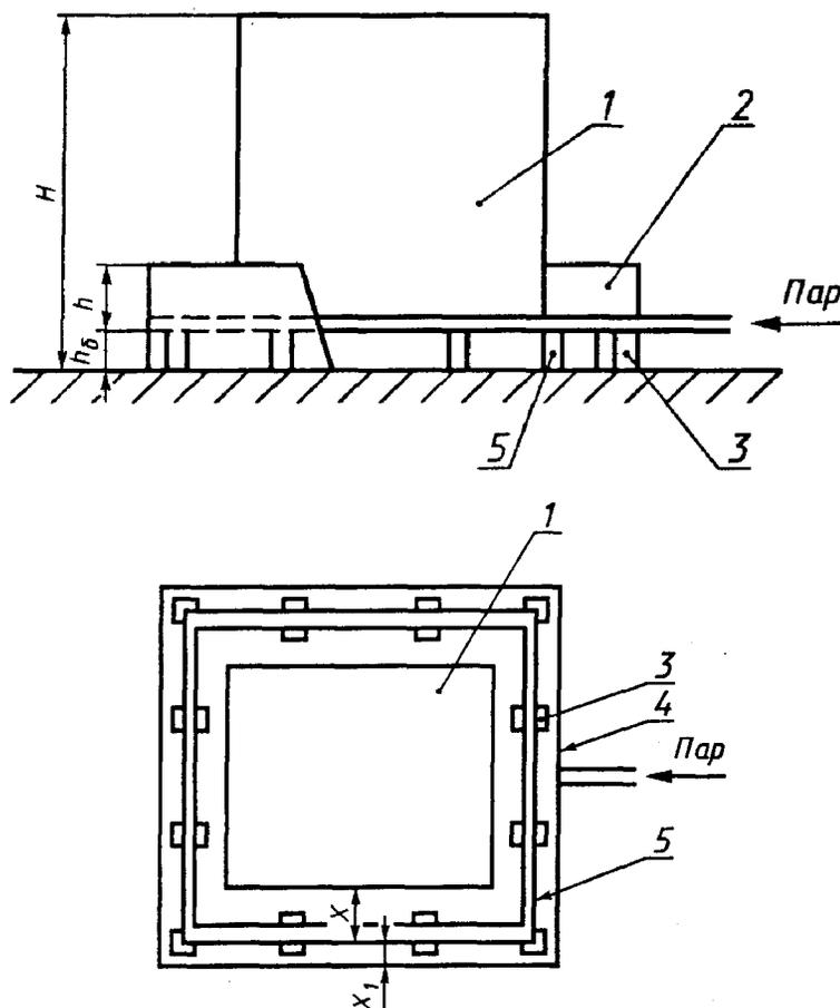
1 — защищаемый объект; 2 — ограждение; 3 — опора коллектора; 4 — коллектор; 5 — дренажный вентиль;  $h$  — высота верхней кромки ограждения над коллектором;  $h_б$  — высота опоры;  $X$  — расстояние от коллектора до защищаемой стороны объекта;  $X_1$  — расстояние от ограждения до коллектора
