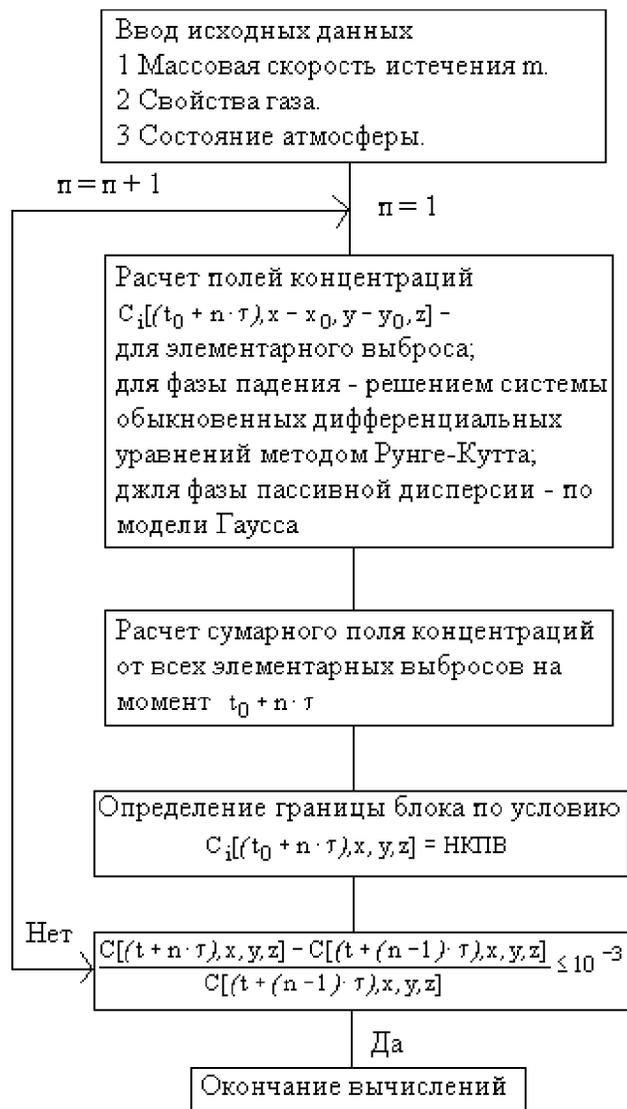
Рисунок Г. 1 — Алгоритм расчета параметров паровоздушного облака
