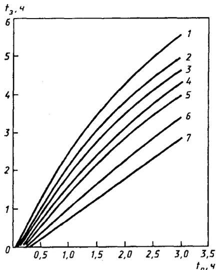
продолжительности пожара  $t_3$  от продолжительности пожара  $t_n$  для вертикальных незащищенных металлических конструкций
