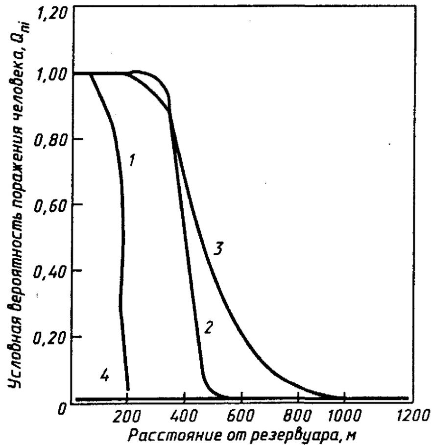
1 — пожар пролива; 2 — «огненный пар»; 3 — сгорание с развитием избыточного давления; 4 — пороговое значение  $Q_{\pi i} = 1 \cdot 10^{-2} \text{ год}^{-1}$
