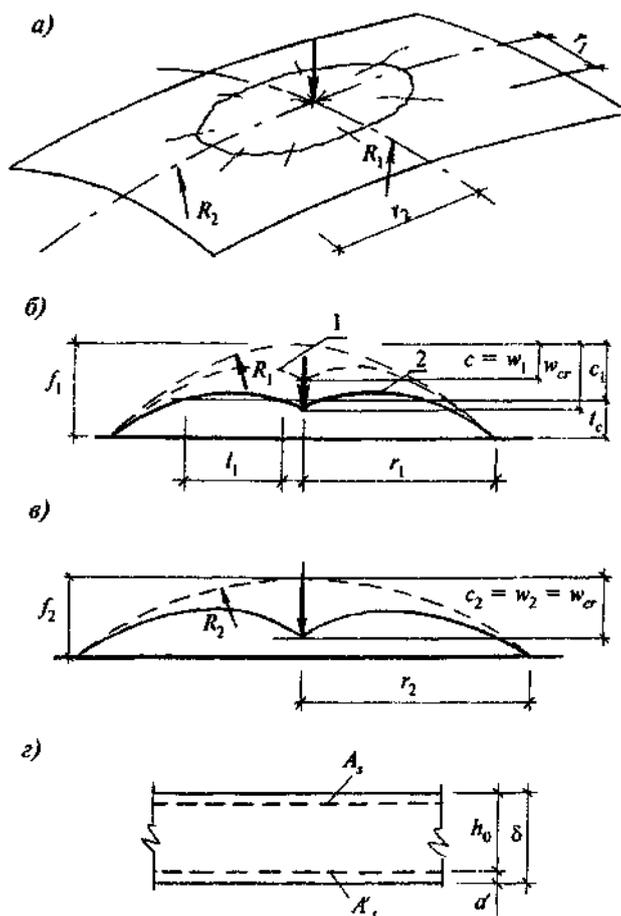
а - схема излома; б, в - схемы деформирования; г - схема армирования поперечного сечения
