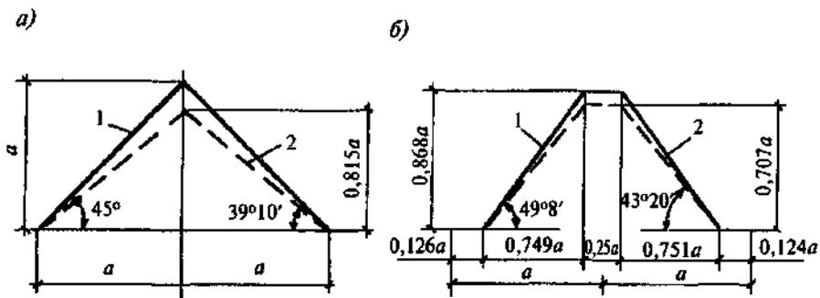
$a$  - треугольные сечения;  $b$  - трапециевидные сечения; 1 - для нагрузки постоянной интенсивности по ширине складки; 2 - для нагрузки собственного веса складки
