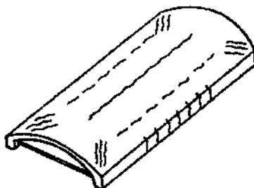
**Рисунок 9.6** - Схема трещин в длинной цилиндрической оболочке
