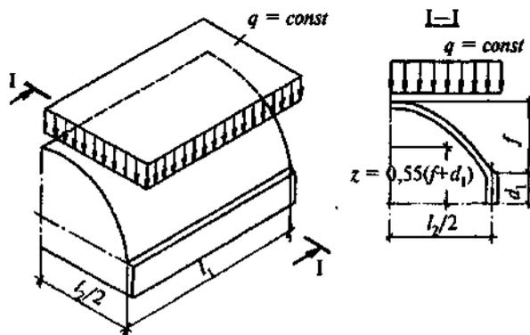
Рисунок 9.17 - К расчету бортового элемента короткой цилиндрической оболочки
