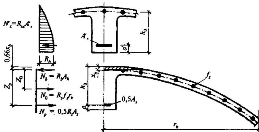
Рисунок 11.20 - Схема взаимодействия усилий в радиальном сечении оболочек
