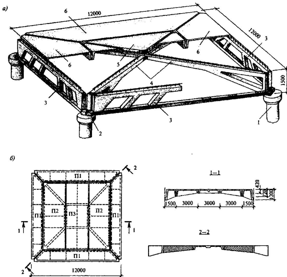
а - для нагрузки до 30 кН/м<sup>2</sup>; б - для нагрузки до 10 кН/м<sup>2</sup>; 1, 2 - колонны с капителями; 3 - бортовые элементы; 4 - диагональные рамы; 5, 6 - плиты настила; 7 - диагональные ребра плит переменной высоты
