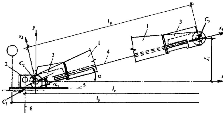
1 - панель-оболочка КЖС; 2 - упор затяжки; 3 - закладная деталь с отверстием для шарнира; 4 - ось рабочей арматуры диафрагм; 5 - ось затяжки; 6 - ось опорной конструкции
