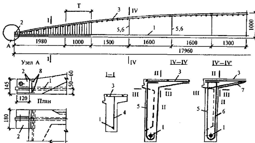
1 - напрягаемая арматура диафрагмы; 2 - анкер; 3 - арматурная сетка оболочки; 4 - поперечная арматура диафрагмы (на участке Т устанавливается только при наличии подвесного транспорта); 5 - подвеска наружная; 6 - подвеска внутренняя; 7 - сетка в вуте; 8 - торцевая арматура (сечение IV'-IV' при наличии подвесных кранов и для сегментных сводов)
