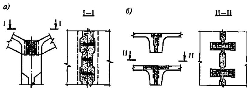
а - ребристых плит с бортовыми балками в отдельно стоящей складке между ребрами и в местах ребер; б - панелей в угловых зонах (со сваркой выпусков и со сварными каркасами, устанавливаемыми в углублениях сверху)
