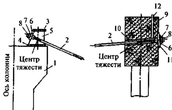
1 - центральная колонна; 2 - ванты; 3 - верхний пояс центрального кольца; 4 - нижний пояс центрального кольца; 5 - соединительные опорные планки; 6 - шайба; 7 - гайка; 8 - хвостовик; 9 - опорный контур; 10 - закладная трубка для пропуска ванты; 11 - закладная деталь, распределяющая нагрузку от ванты; 12 - патрубок для инъекции раствора
