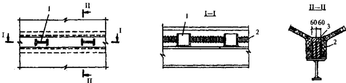
*1* - стальной упор; *2* - шпонки; *3* - бетон замоноличивания
