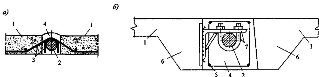
*a* - плоская плита; *б* - ребристая плита; 1 - железобетонная плита; 2 - ванта; 3 - крюки; 4 - бетон шва; 5 - армирование шва; 6 - ребро плиты; 7 - детали крепления плит к вантам
