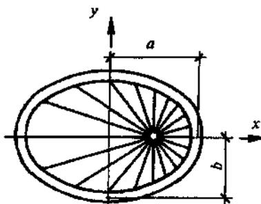
Рисунок 13.12 - Радиально-вантовая система с узлом в фокусе эллипса
