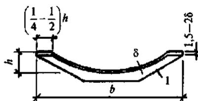
*l* - ребра по поперечным краям элементов
