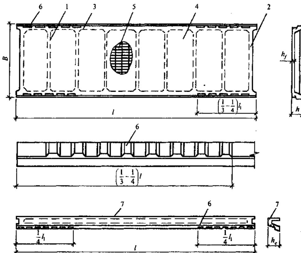
1 - поперечное ребро; 2 - то же, торцевое; 3 - то же, продольное; 4 - полка плиты; 5 - арматурная сетка полки; 6 - пазы на продольных ребрах плиты и бортового элемента; 7 - крайний бортовой элемент
