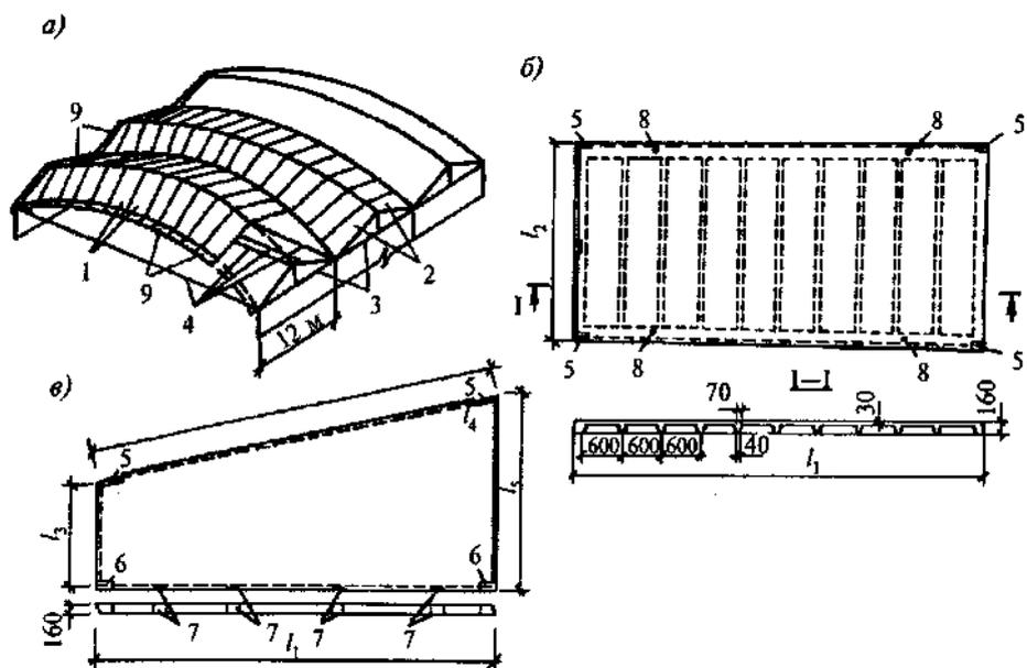
*а* - общий вид; *б* - рядовая панель; *в* - опорная панель; 1 - рядовые панели; 2 - опорные панели; 3 - опорные фермы; 4 - затяжки; 5 - закладные швеллеры, усиленные пластиной; 6 - закладные уголки; 7 - закладные пластинки; 8 - отверстия для строповки панелей и установки бандажей; 9 - плиты торцевого карниза
