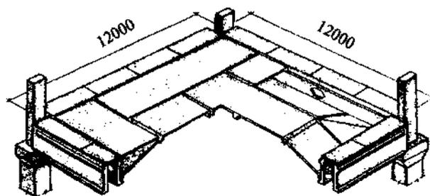
**Рисунок 16.6 - Ячейка сборного шатрового перекрытия под тяжелые нагрузки**
