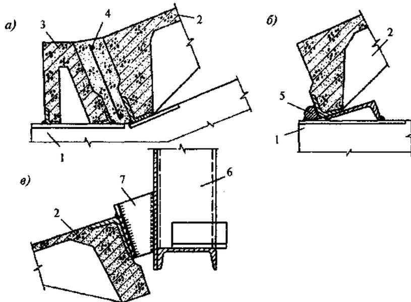
*а* - сопряжение диафрагмы с бортовым элементом и плитой неразрезного складчатого покрытия; *б* - то же, с плитой разрезного складчатого покрытия; *в* - крепление плиты к фонарной панели; 1 - диафрагма; 2 - плита складки; 3 - бортовой элемент; 4 - арматурный каркас в шве замоноличивания; 5 - стальной упор; 6 - фонарная панель; 7- соединительная планка-подвеска
