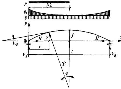
Рисунок 7.4 - Расчетная схема свода
