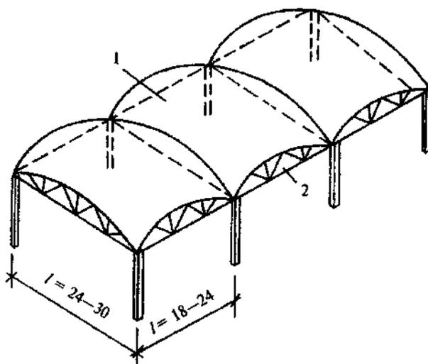
1 - монолитная плита-оболочка; 2 - металлическая или сборная железобетонная ферма-диафрагма
