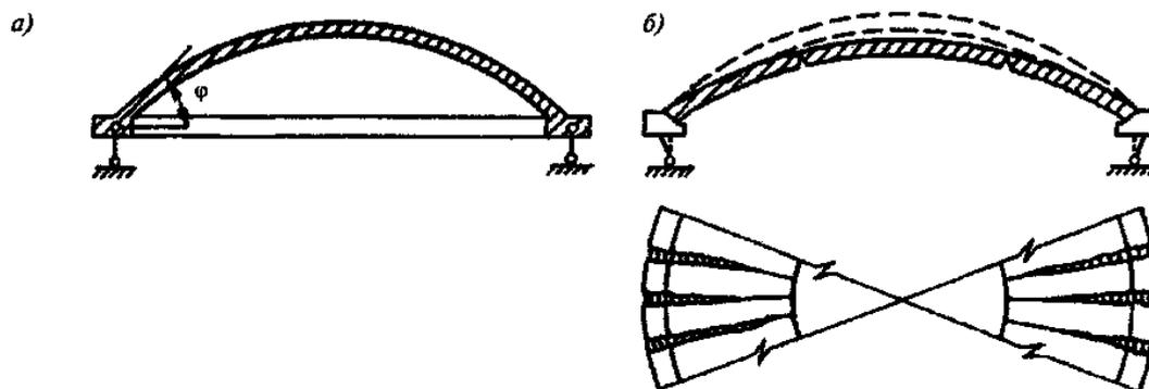
а - поперечное сечение; б - схема разрушения
