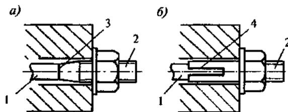
*a* - с расчетным сопротивлением, равным расчетному сопротивлению материала вант; *б* - с расчетным сопротивлением, меньшим расчетного сопротивления материала вант; 1 - ванта; 2 - хвостовик; 3 - контактная сварка; 4 - то же, дуговая
