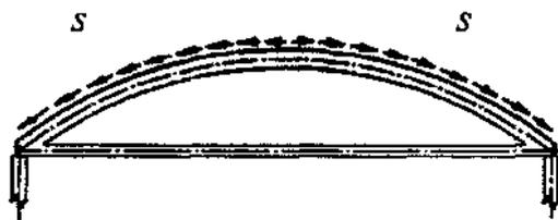
Рисунок 9.9 - Схема передачи усилий с оболочки на диафрагму
