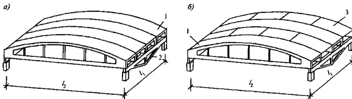
а - покрытие с применением только панелей-оболочек КСО; б - покрытие с применением панелей-оболочек КСО и дополнительных цилиндрических пластин-оболочек; 1 - панели-оболочки КСО; 2 - опорные конструкции в виде ферм;
