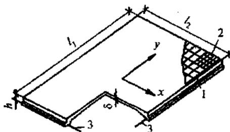
1 - арматурная сетка; 2 - дополнительные сетки в углах панели; 3 - предварительно напряженный арматурный пояс
