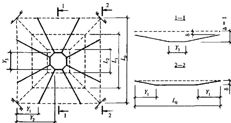
Рисунок 16.4 - Девятизвенная схема излома
