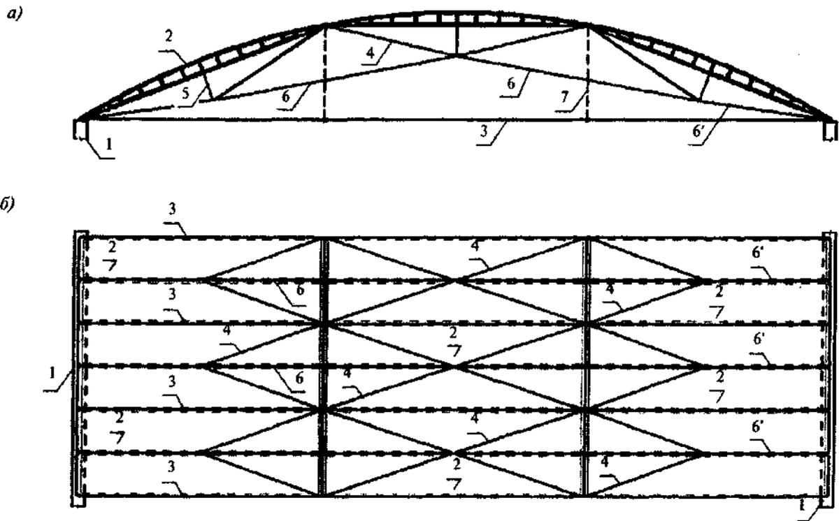
*a* - вид сбоку; *б* - план свода, состоящего по длине из 6 панелей-оболочек КЖС; 1 - опорная конструкция; 2 - панели-оболочки КЖС; 3 - затяжки; 4 - наклонные связи, образующие в плане ромбическую систему связей; 5 - стойки, снабженные напрягающим устройством; 6 - дополнительные стержни, соединяющие нижние углы треугольной решетки; 6' - опорная связь треугольной решетки
