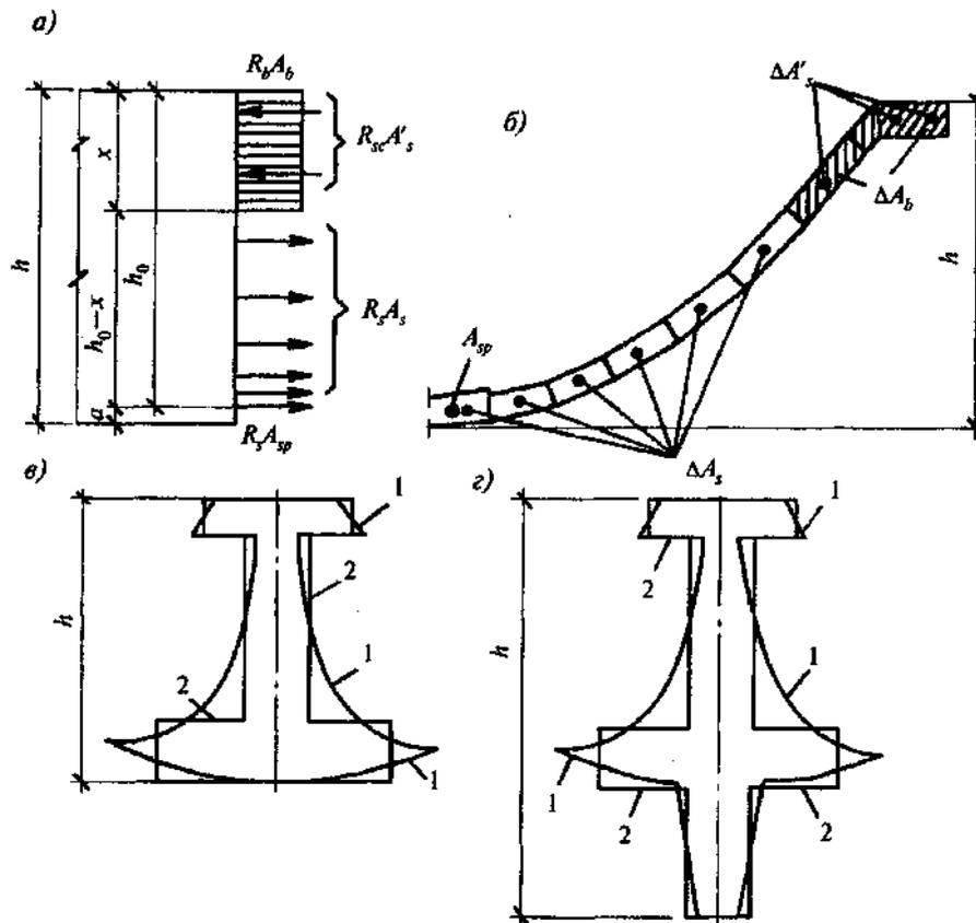
*a* - схема усилий в поперечном сечении изгибаемой волны; *б* - разбивка на элементарные площадки половины поперечного сечения; *в* - приведенное поперечное сечение при расчете на изгиб панели-оболочки; *г* - то же, килевой панели-оболочки; 1 - контур фактического приведенного сечения; 2 - то же, расчетного приведенного сечения
