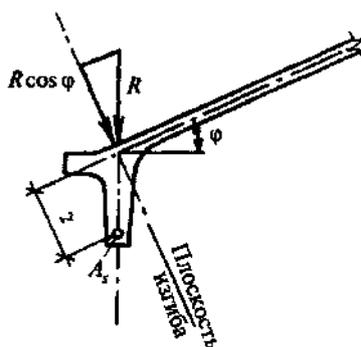
Рисунок 16.5 - Расчетная плоскость изгиба крайних элементов шатровых складок
