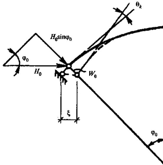
Рисунок 10.3 - Перемещения края оболочки, вызванные радиальным распором  $H_0$
