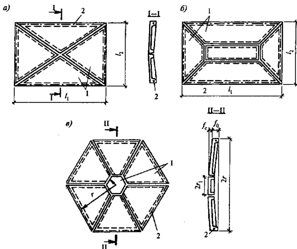
*a* - на прямоугольном плане из треугольных элементов; *б* - на прямоугольном плане из прямоугольного и трапецевидных элементов; *в* - на полигональном контуре; 1 - сборные панели; 2 - арматурный пояс
