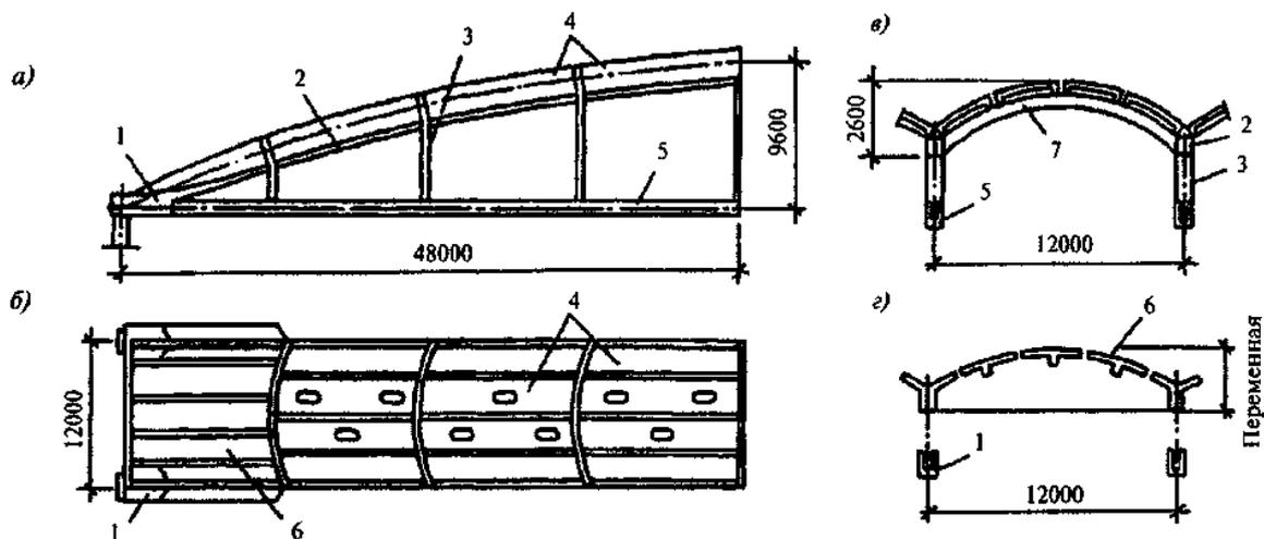
*а* - продольный разрез по своду; *б* - план раскладки плит; *в* - поперечный разрез по средней зоне; *г* - то же, по опорной зоне; 1 - опорный блок; 2 - бортовые элементы; 3 - стальная подвеска; 4 - средняя плита с отверстиями; 5 - блок затяжки; 6 - плита опорной зоны; 7 - балка диафрагмы
