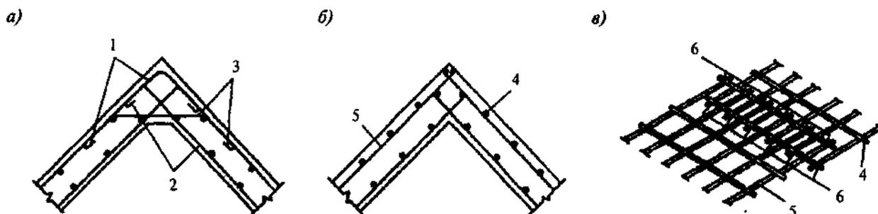
а - отдельными стержнями; б - сварными сетками; в - положение сеток при сварке; 1 - верхние стержни; 2 - то же, нижние; 3 - армирование в вутах; 4 - поперечные стержни пересекающихся сеток; 5 - то же, продольные; 6 - места точечной сварки
