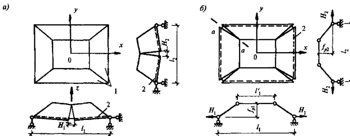
*a* - с изломом посередине пролета (балочная схема); *б* - с разделением на 5 дисков (шатровая схема излома);
