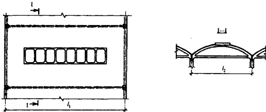
Рисунок 9.13 - Схема оболочки с фонарным проемом
