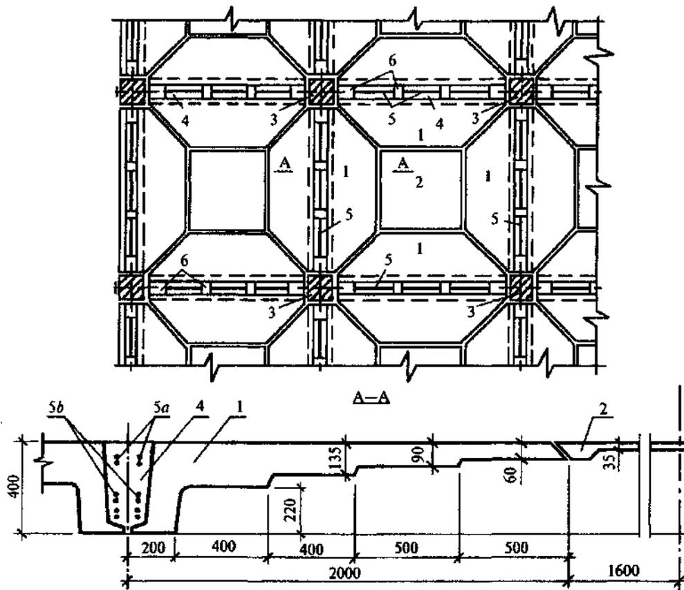
1 - контурный элемент; 2 - центральная плита; 3 - колонна с отверстиями для пропуска напрягаемой арматуры; 4 - замоноличиваемые пазы; 5 - напрягаемая арматура; 6 - стальная пластина для сварного соединения сборных элементов; в сечении А-А: 5а и 5б - положение верхней арматуры соответственно в опорном сечении и в средней части пролета
