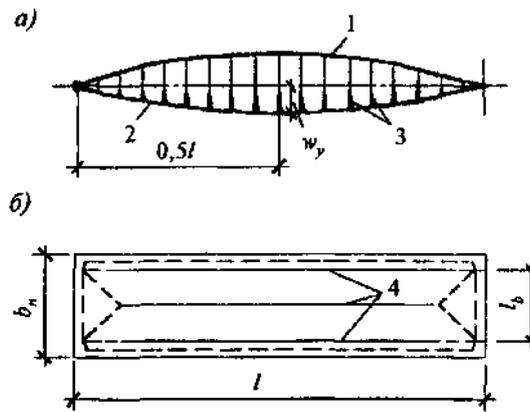
*a* - вид на диафрагму; *б* - план; 1 - оболочка; 2 - рабочая арматура диафрагм; 3 - трещины в диафрагме; 4 - пластические шарниры в оболочке
