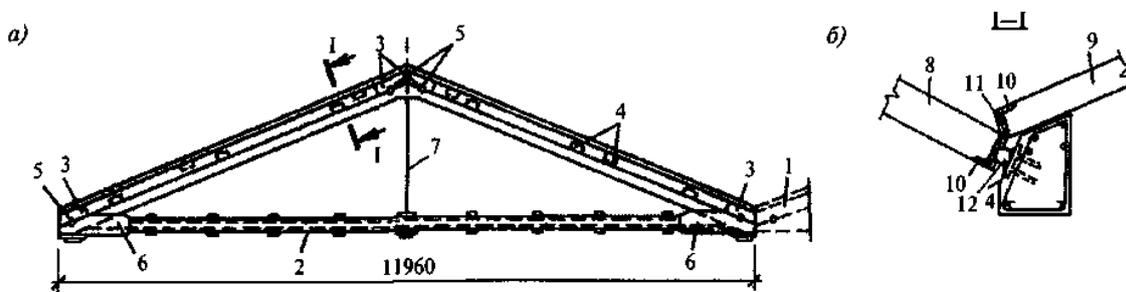
а - опорная ферма; б - примыкание к ферме опорных панелей и плит продольного карниза; 1 - консоль для опирания торцевого карниза у ферм, установленных в крайних пролетах; 2 - швеллеры; 3 - пластина; 4 - закладные пластины; 5 - отверстия для затяжек; 6 - накладка; 7 - подвеска; 8 - опорная панель; 9 - плита продольного карниза; 10 - закладные уголки; 11 - анкер; 12 - фиксатор (стержень,  $l = 80-100$  мм)
