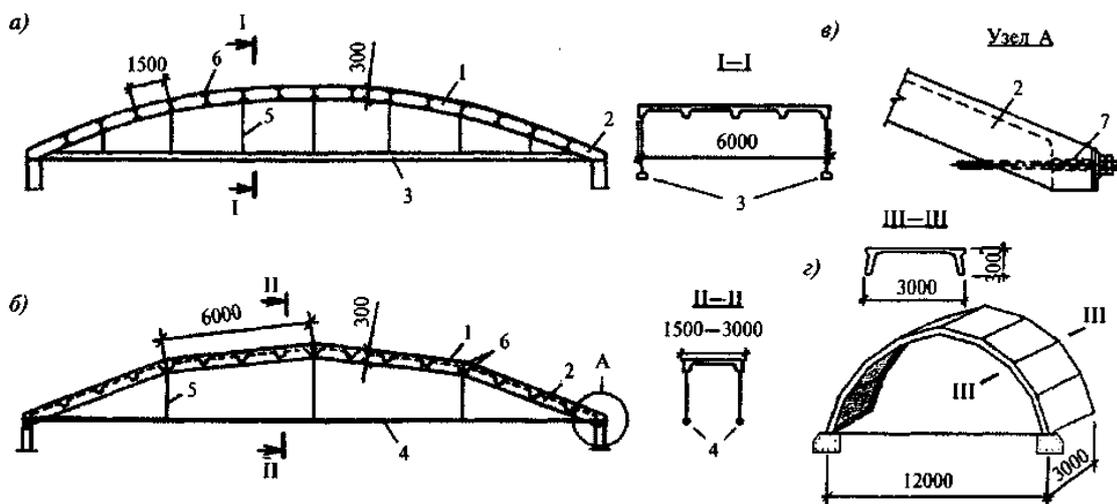
а - из секций шириной 6 м; б - то же, шириной 1,5 - 3 м; в - опорный узел; г - свод из складчатых ребристых панелей; 1 - рядовые панели; 2 - опорные панели; 3, 4 - предварительно напряженные железобетонные или стальные затяжки; 5 - подвески; 6 - накладки; 7 - отверстие для затяжки
