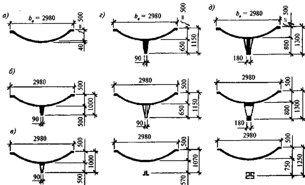
*a* - пролетом 12 м; *б, в* - то же, 18 м (со сплошным килем и с отверстиями в нем); *г* - то же, 21 м (со сплошным и облегченным килем и с затяжкой); *д* - то же, 24 м (с облегченным килем, с отверстиями в нем и с затяжкой)
