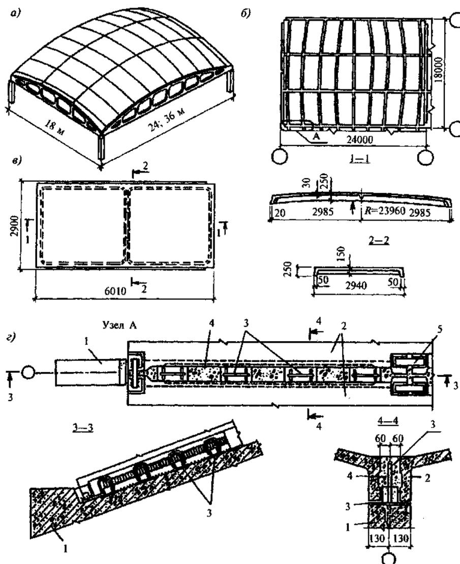
*a* - общий вид оболочки; *б* - план оболочки размером 18×24 м; *в* - цилиндрические ребристые панели размером 3×6 м; *г* - деталь сопряжения смежных оболочек; 1 - железобетонный упор верхнего пояса диафрагмы; 2 - контурные плиты; 3 - стальные упоры; 4 - бетон замоноличивания угловой зоны; 5 - соединительные накладки
