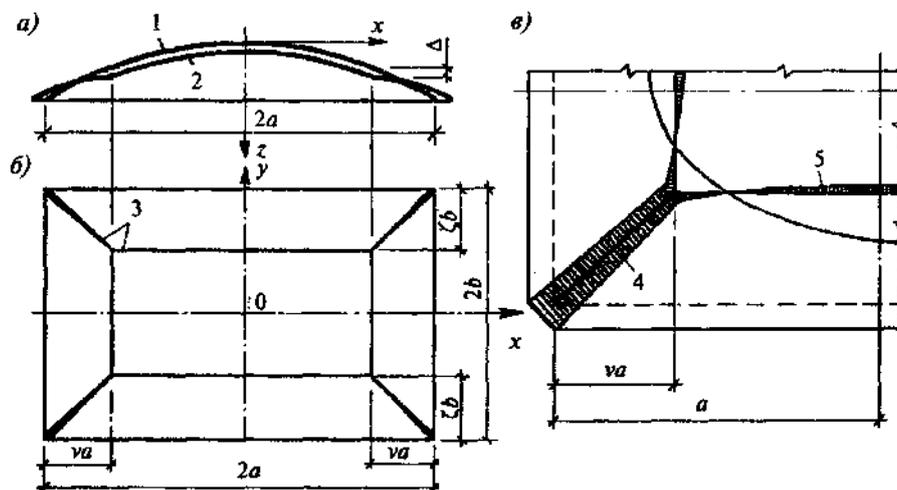
*a* - механизм разрушения; *б* - схема излома оболочки в плане; *в* - эпюры пластических деформаций по линиям излома; 1 - первоначальная форма оболочки; 2 - форма оболочки в стадии предельного равновесия; 3 - линии излома (пластические шарниры); 4 - растянутые (разрывные) участки линий излома; 5 - то же, сжатые
