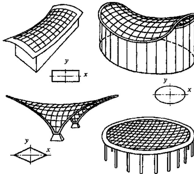
Рисунок 13.4 - Висячие оболочки с перекрестной системой вант
