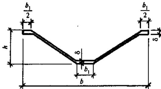
Рисунок 7.13 - Трапециевидное поперечное сечение элемента свода
