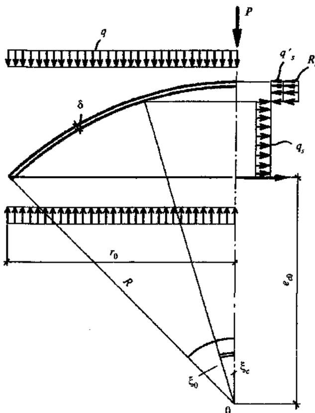
Рисунок 10.8 - К расчету купола по «балочной» схеме
