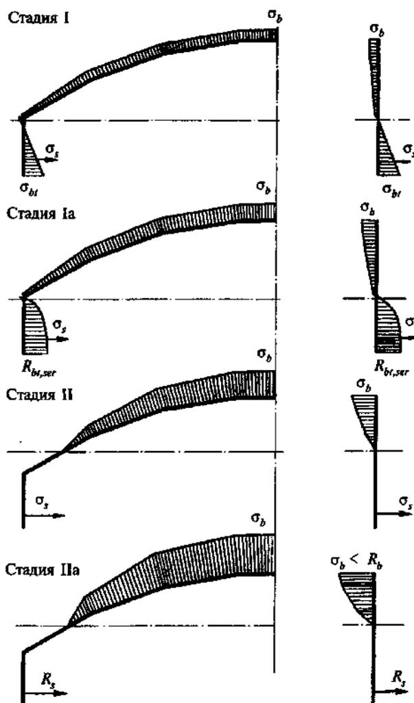
Рисунок 9.7 - Стадии напряженного состояния поперечных сечений оболочки (складки)
