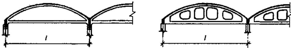
Рисунок 9.12 - Диафрагмы цилиндрических оболочек
