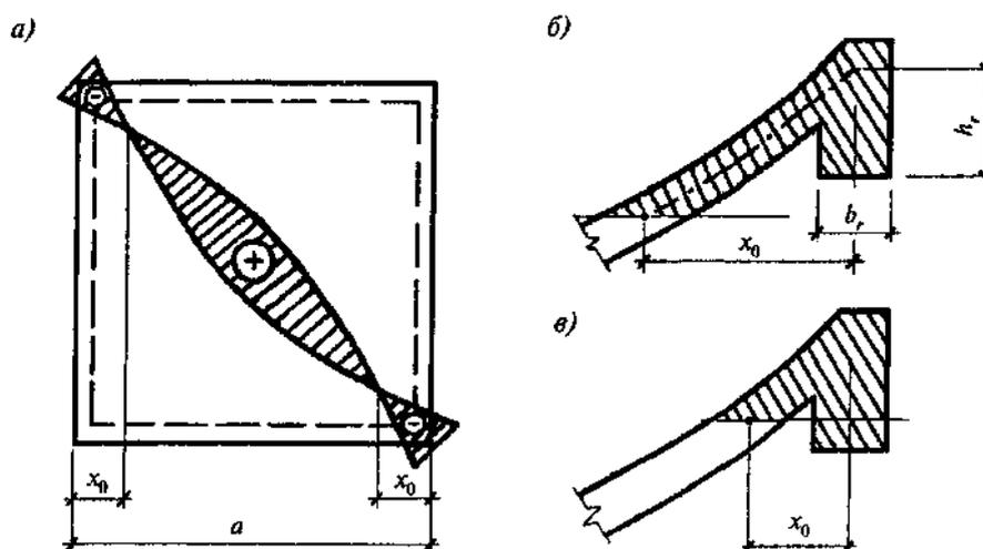
*a* - схема излома; *б, в* - схемы расположения нейтральной оси
