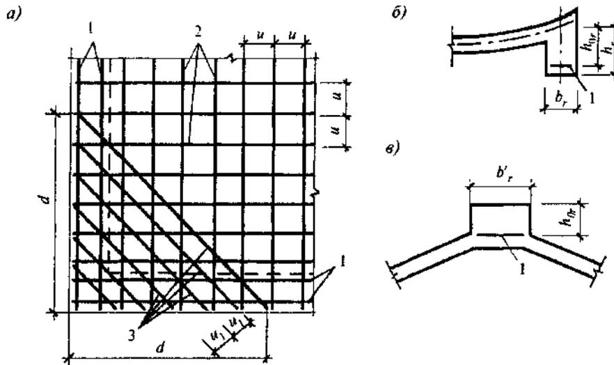
*a* - армирование нижнего угла; *б* - примыкание оболочки к контурному ребру; *в* - то же, к коньковому ребру в четырехлепестковом покрытии с горизонтальными коньками; 1 - арматура ребра; 2 - арматура поля оболочки; 3 - угловая арматура
