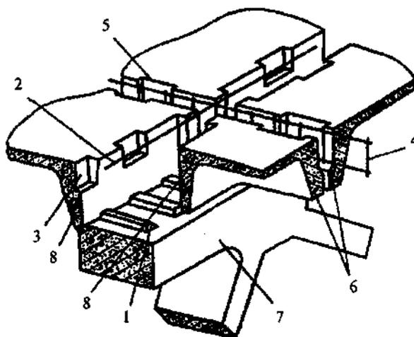
1 - бетонные шипы на верхнем поясе диафрагмы; 2 - стержень, армирующий комплексное сечение; 3 - пазы на торцевых ребрах плит; 4 - каркас в продольном шве между плитами над диафрагмами; 5 - пазы на продольных ребрах плит; 6 - продольные ребра плит; 7 - верхний пояс диафрагмы; 8 - торцевые ребра плит
