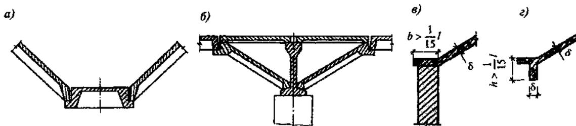
а - П-образных; б - двугавровых с плитами поверху; в - крайних; г - при опирании на колонны
