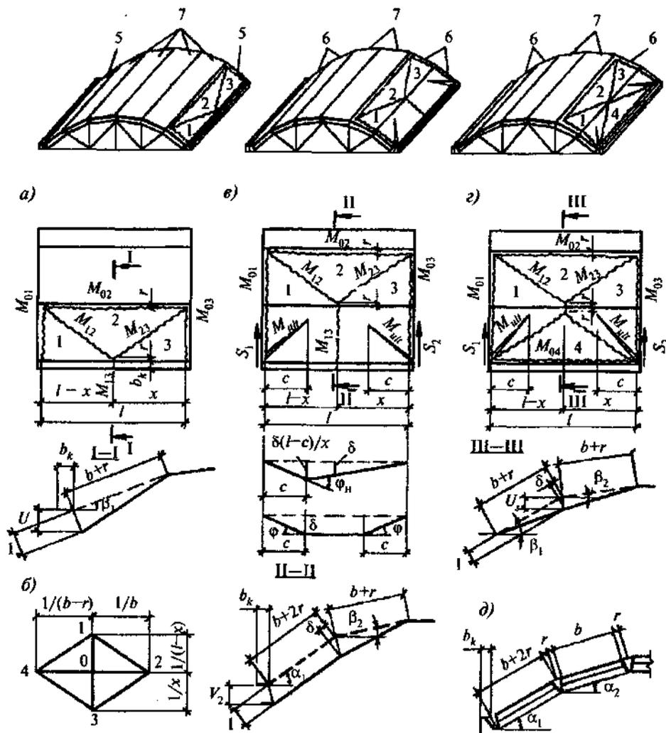
*a* - схемы разрушения первой грани складки и бортового элемента; *б* - диаграмма скоростей виртуальных перемещений; *в* - схема разрушений двух граней складки с изломом бортового элемента; *г* - то же, без излома бортового элемента; *д* - поперечное сечение складки у края; 1-4 - звенья в схемах разрушения; 5 - первые грани складки; 6 - первая и вторая крайние грани складки; 7 - средняя часть складки
