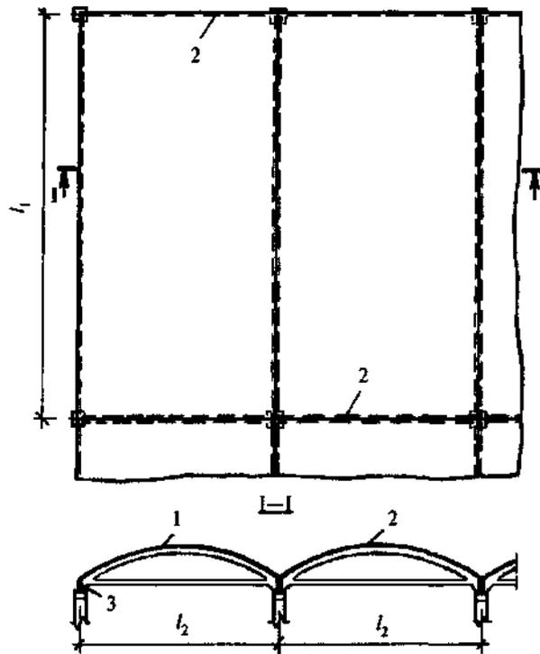
1 - плита оболочки; 2 - диафрагма; 3 - бортовой элемент
