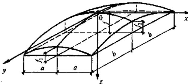
Рисунок 11.2 - Схема оболочки положительной гауссовой кривизны
