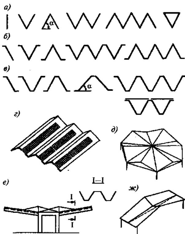
*a* - треугольные складки, образуемые из плоских элементов (плит); *б* - то же, из Г-образных элементов; *в* - трапециевидные складки, образуемые из Z-образных элементов; *г* - устройство световых проемов в треугольных и трапециевидных складках; *д* - треугольные складки переменного сечения на полигональном плане; *е* - призматические трапециевидные складки в консольном подвесном покрытии; *ж* - балочная складка с
