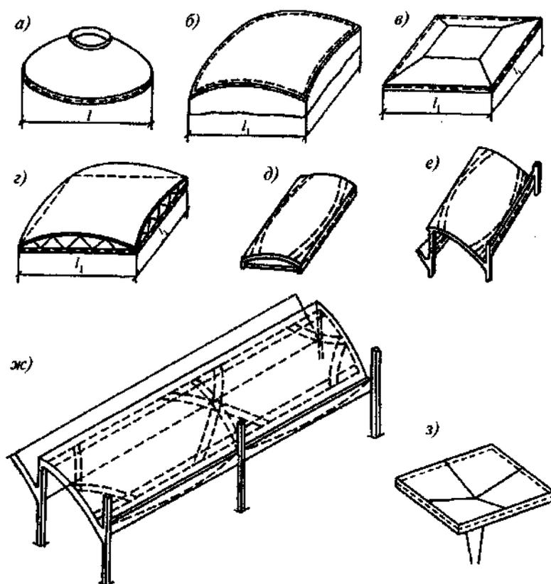
*a* - в куполе; *б* - в шатровой складке; *в* - в полой оболочке положительной гауссовой кривизны, опертой по контуру; *г* - то же, с фермами-диафрагмами, опертыми в углах оболочки; *д* - в цилиндрической оболочке; *е* - в шедовой однопролетной оболочке; *ж* - в шедовой неразрезной оболочке, армированной перекрестными пучками; *з* - в зонтичной оболочке, образованной из четырех гиперболических параболоидов
