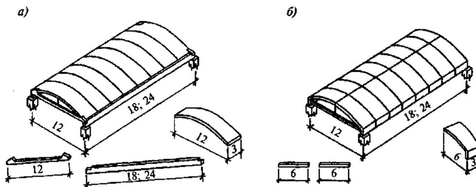
а - из бортовых балок, криволинейных ребристых панелей и затяжек диафрагм; б - из криволинейных ребристых панелей с бортовым элементом и затяжек диафрагм
