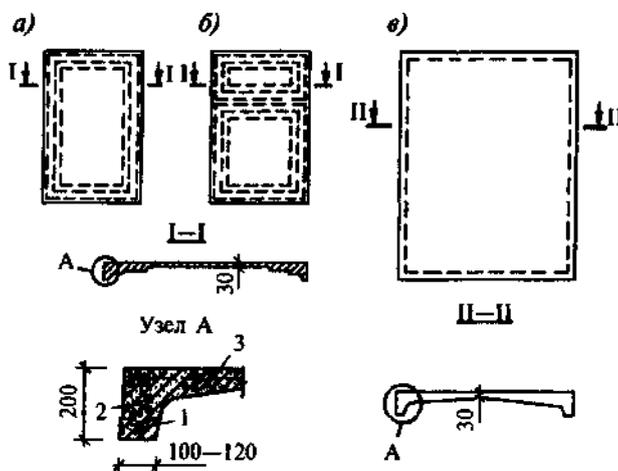
*a* - ступенчато-вспарушенная панель с одним кессоном; *б* - ступенчато-вспарушенная панель с двумя кессонами; *в* - вспарушенная панель; 1 - основная растянутая арматура пояса; 2 - каркас поперечного армирования контурного ребра; 3 - сетка плиты
