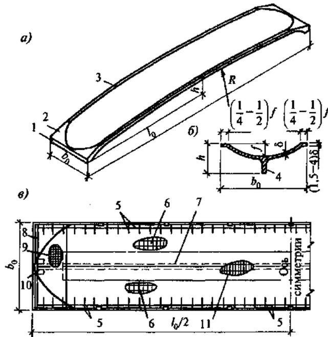
*a* - общий вид; *b* - поперечное сечение; *в* - план армирования; 1 - торцевое ребро; 2 - наклонная торцевая диафрагма; 3 - продольный борт; 4 - киль; 5 - каркас продольного борта; 6 - сварная сетка оболочки; 7 - предварительно напряженная арматура; 8 - арматура торцевого ребра; 9 - верхняя сварная сетка у торца панели; 10 - то же, нижняя; 11 - верхняя сварная сетка над килем
