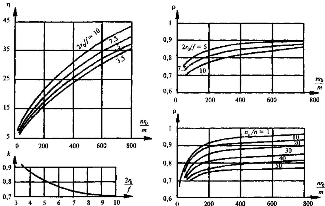
Рисунок 10.7 - Графики для определения коэффициентов  $\eta$ ,  $k$ ,  $\rho$
