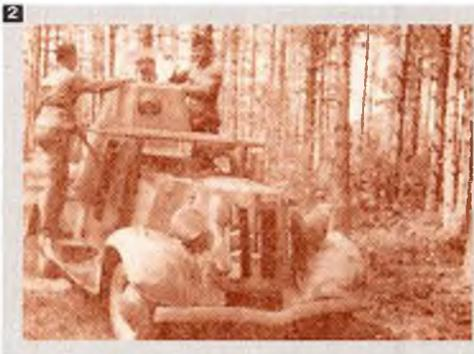
с приводом только на заднюю ось. Дополнительное бронирование и увеличение экипажа привело к возрастанию массы броневомобиля до 2,52 т, что не могло не сказаться на скорости, которая снизилась до 50 км/ч 1
