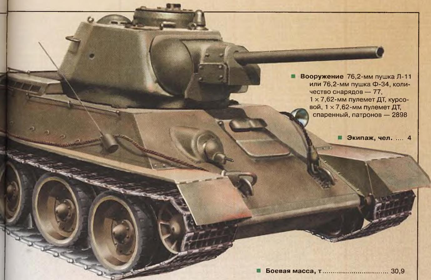
■ **Вооружение** 76,2-мм пушка Л-11 или 76,2-мм пушка Ф-34, количество снарядов — 77, 1 × 7,62-мм пулемет ДТ, курсовой, 1 × 7,62-мм пулемет ДТ, спаренный, патронов — 2898
