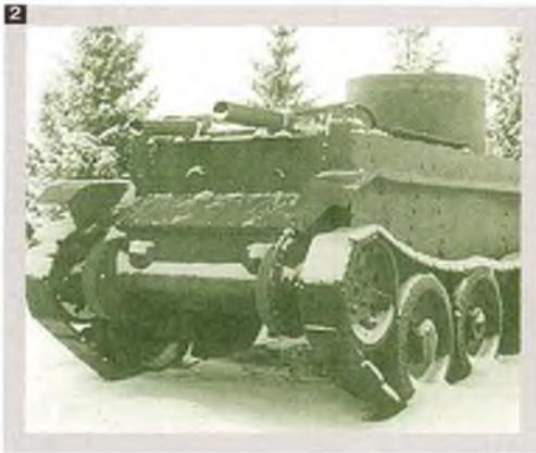
В башне размещались 37-мм пушка Б-3(5К) образца 1931 г. и
