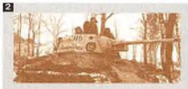
обрезиненные; литые с ребрами жесткости и круглыми отверстиями на диске, обрезиненные; литые с ребрами жесткости, круглыми отверстиями и внутренней амортизацией. Более мощную радиостанцию 9-Р вместо 71-ТК-3 стали устанавливать на всех машинах, а не только на командирских. Масса танка увеличилась с 28,5 до 30,9 т.
