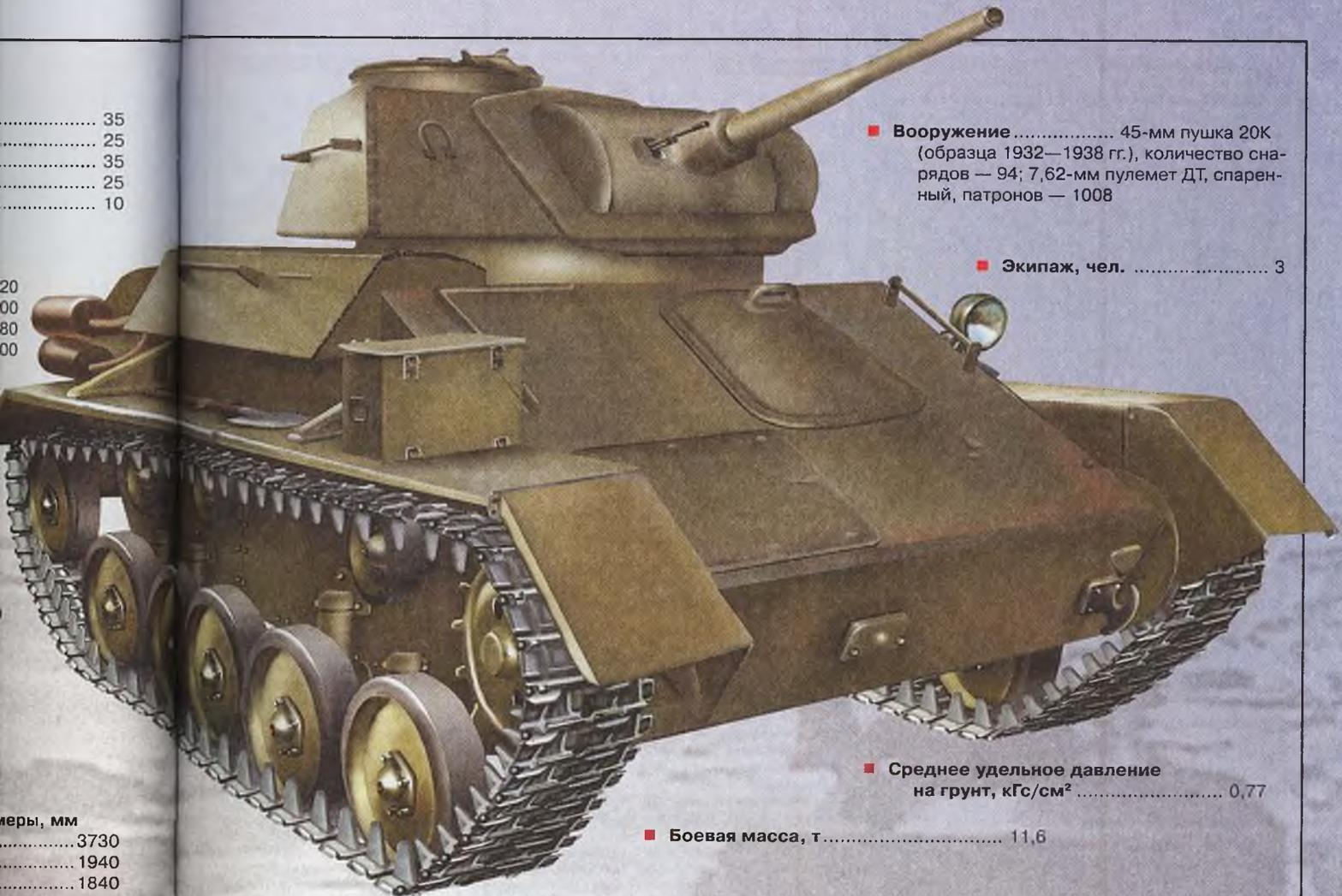
■ **Вооружение** ..... 45-мм пушка 20К (образца 1932—1938 гг.), количество снарядов — 94; 7,62-мм пулемет ДТ, спаренный, патронов — 1008
