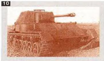
В таком виде спроектированная самоходная установка (заводская марка СУ-12) была изготовлена осенью 1942 г. и в декабре поступила на испытания, которые были краткими и существенных дефектов не выявили. Под названием
