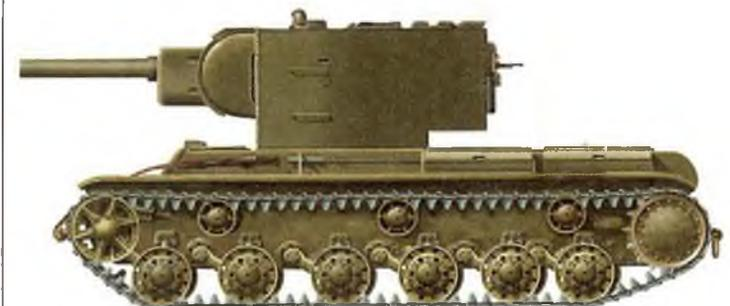
стью и достаточной мощностью. Лобовая 75-мм броня корпуса с любой дистанции не пробивалась снарядами противотанковых орудий.
