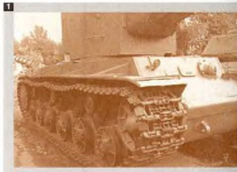
никло множество вопросов: не опрокинется ли при выстреле танк, как смогут выдержать большую массу ходовая часть и трансмиссия и ряд других. Но несмотря на это, конструктор был уверен в расчетах и надежности своей машины, база КВ-1 уже была испытана. Ходовая часть танка состояла из широкой мелкозвенчатой гусеницы цепочного зацепления, шести двоярных опорных катков на борт с внутренней амортизаци-
