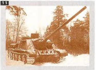
вым зарядом в 85-мм гильзе. Однако комплекс испытаний эта машина не прошла **9**
