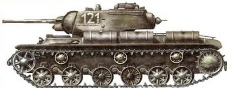
шла успешно, хотя некоторые поправки пришлось внести. Подверглась изменению и силовая передача. Были установлены новый главный фрикцион, новая коробка передач конструкции Н.Ф. Шамшурина с демультпликатором, обеспечившая восемь передач вперед и две назад. В ходовой части применили облегченные ходовые катки и литые катки меньшей ширины. Дополнительно установили топливные баки.
