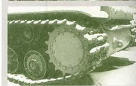
Отличие КВ-1, кроме усиления броневой защиты, применения литой башни с увеличенной толщиной стенок, заключается также в использовании цельнометаллических опорных катков. Ходовая часть состоит из мелкозвенчатой гусеницы цевочного зацепления, шести опорных и трех поддерживающих катков, направляющего колеса с натяжным устройством и ведущего колеса заднего расположения со сменными зубчатыми венцами. Подвеска всех опорных катков — торсионная.
