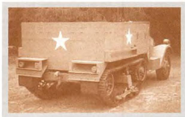
На машине устанавливался четырехтактный 6-цилиндровый карбюраторный двигатель «Уайт-160АХ мощностью 147 л.с. при 3000 об/мин. Главный фрикцион Spicer сухой, односторонний. Коробка передач четырехскоростная. Раздаточная коробка, одновременно являвшаяся демультипликатором и смонтированная в одном картере с коробкой передач, имела две передачи — прямую и замедленную. Она обеспечивала передачу крутящего момента к переднему и заднему ведущим мостам, а также отбор мощности на лебедку.
