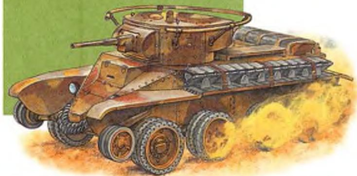
В танковом цехе Харьковского паровозостроительного завода им. Коминтерна в начале осени 1933 г. появился новый вариант легкого танка — БТ-5. По сути это была следующая модернизация танка БТ-2. Основное отличие танка — двухместная башня новой формы со спаренной установкой вооружения. В эту башню установили 45-мм танковую пушку образца 1932 г. и спаренный с ней пулемет ДТ. Пушка была
