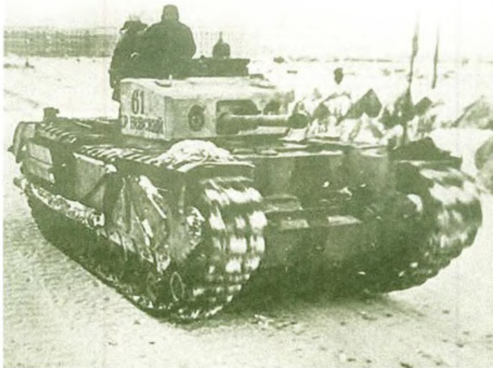
способом изготовления башни и корпуса. При этом масса танка неуклонно возрастала. На модификации Mk II CV ранее устанавливаемую в передней части корпуса 3-дюймовую (76,2-мм) гаубицу разместили в башне. Основные изменения в конструкции Mk III были связаны с установкой 6-фунтовой пушки калибра 57 мм в сварной башне, хотя на Mk IV вер-
