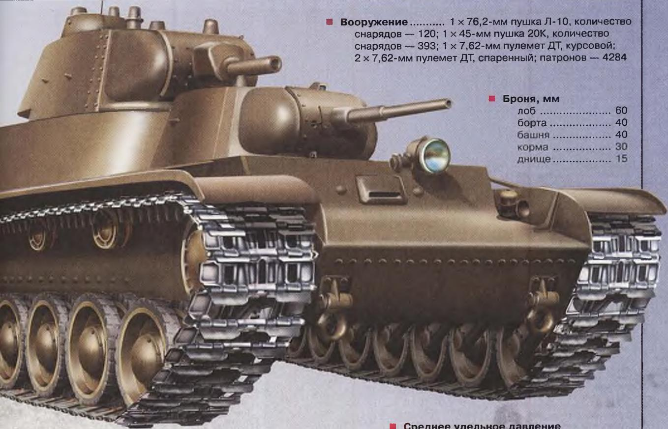
■ **Вооружение** ..... 1 × 76,2-мм пушка Л-10, количество снарядов — 120; 1 × 45-мм пушка 20К, количество снарядов — 393; 1 × 7,62-мм пулемет ДТ, курсовой; 2 × 7,62-мм пулемет ДТ, спаренный; патронов — 4284
