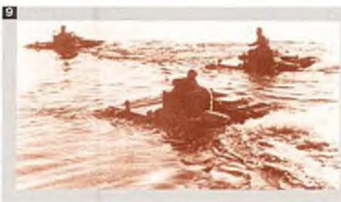
На учениях и маневрах в предвоенные годы отрабатывались методы доставки малых танков по воздуху с помощью бомбардировщиков ТБ-3 в районы сосредоточения **8**, **9**. Прочность плавающих танков допускала их сброс на воду с высоты 6 м от поверхности реки при скорости самолета 160 км/ч. Экипажи десантировались на парашютах. На Медвежьих озерах под Москвой был произведен сброс Т-37А с ТБ-3 на воду. Машина удачно приводнилась, но затонула из-за недостаточной герметизации смотровых щелей.
