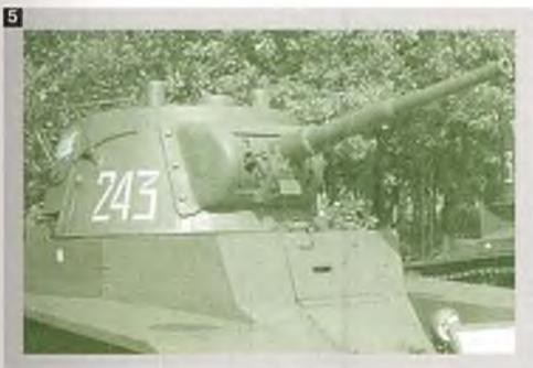
Особенностями опытного танка БТ-7 стали башня в форме конуса со скошенной крышей и курсовой пулемет справа от люка механика-водителя. Башня была унифицирована под любую танковую пушку того времени — ПС-3 или КТ калибра 76 мм или 20К калибра 45 мм. Боезапас размещался в нише башни и представлял собой боеукладку барабанного типа. Для командирских танков вместо боезапаса в башне устанавливалась радиостанция.
