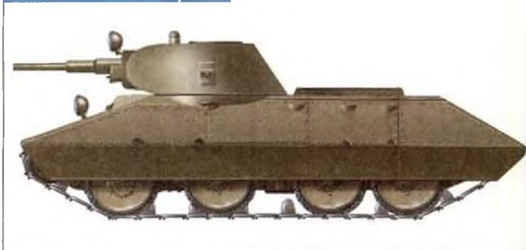
катки крепились аналогично остальным на наклонной пружинной рессоре.
