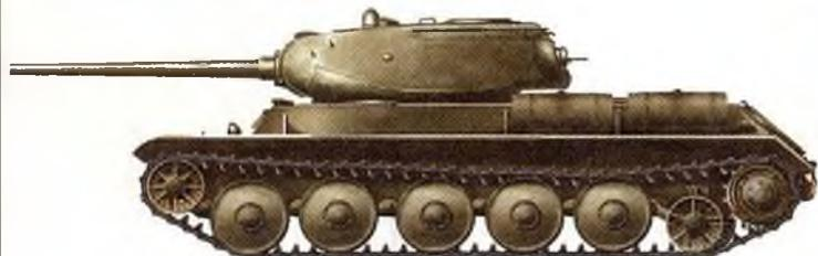
Во второй половине 1942 г. в КБ челябинского Кировского завода был разработан тяжелый танк ИС-1. Основой послужил танк КВ-13, на базе которого изготовили два опытных образца тяжелой машины — ИС-1 и ИС-2, различие которых состояло в вооружении: на первой была установлена 76-мм пушка, на второй — 122-мм пушка-гаубица. Взятый за основу танк КВ-13 был первой значительной работой Опытного танкового завода, созданного на базе СКБ в марте 1942 г. **1**
