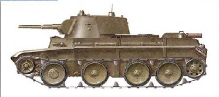
Корпус серийного БТ-7 выпуска 1935 г. собирался из катаных броневых и стальных листов. Бортовые стенки, как и у предшественников БТ-2 и БТ-5, были двойными. Носовая часть несколько закруглена, все соединения корпуса были преимущественно сварными.
