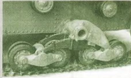
В подвеске танка на каждом борту имелось по две тележки, каждая из которых состояла из четырех сдвоенных опорных катков, соединенных попарно балансирами, двух листовых рессор и соединительной коробки. На каждом борту закреплялись по четыре сдвоенных поддерживающих катка. Все катки были обрешинены.
