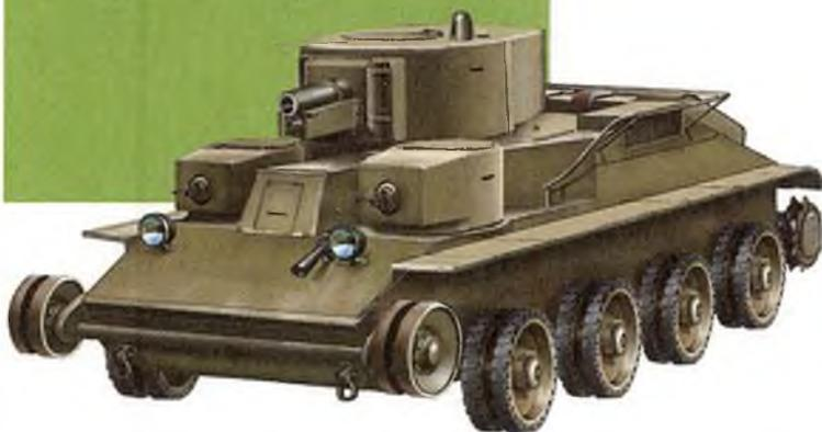
разработан эскизный проект танка ИТ-3 (истребитель танков). Предполагалось, что танк будет иметь колесно-гусеничный движитель, усиленную броневую защиту, 76,2-мм пушку, два пулемета калибра 12,7-мм и 7,62-мм, а также зенитный пулемет. Башню и части корпуса предполагалось делать штампованными. В качестве силовой установки предполагалось использовать хорошо зарекомендовавший себя на танках БТ двигатель М-17Ф.
