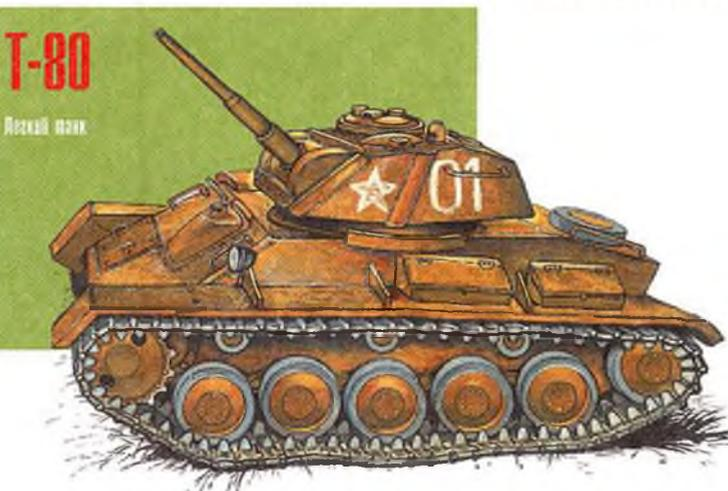
В 1942 г. на Горьковском автомобильном заводе была разработана новая боевая машина. За ее основу были взяты детали и узлы от танка Т-70 М. Толщину бортовой брони нового танка увеличили до 25 мм. Танку был присвоен индекс Т-80.
