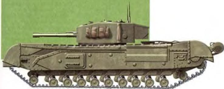
В начале 1940 г. специалисты фирмы «Воксхолл Моторс» приступили к разработке танка (проект А22), который, по мнению военных, должен был не только иметь хорошие огневую мощь и бронирование, но и, учитывая опыт использования танков в Первой мировой войне, успешно действовать на сильно пересеченной, изрытой воронками местности, напоминая Западный фронт
