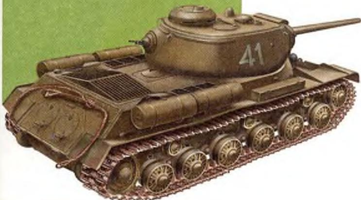
Опытный тяжелый танк ИС-1 с 122-мм гаубицей
