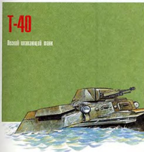
К 1938 г. стала очевидной необходимость создания качественно нового по сравнению с Т-37 и Т-38 плавающего танка с броней, предохраняющей экипаж от бронебойных пуль обычного калибра и крупных осколков снарядов и бомб. Для повышения огневой мощи требовалось установить крупнокалиберный пулемет в сочетании с обычным, оснастить танк радиостанцией, увеличить мощность силовой установки, усилить ходовую часть и подвеску, повысить водоходные качества.
