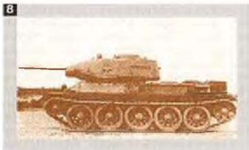
При испытаниях обнаружилось сильное влияние отдачи при выстреле на трансмиссию и ходовую часть, не решила проблему и установка щелевого тормоза.
