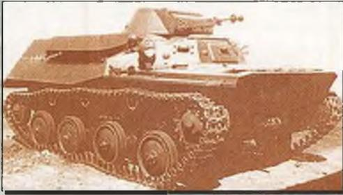
■ **Легкий плавающий танк Т-40**
