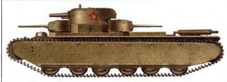
Этот танк создавался как боевая бронированная машина качественно усиления при прорывах сильно укрепленных полос. Выпуск его про-
