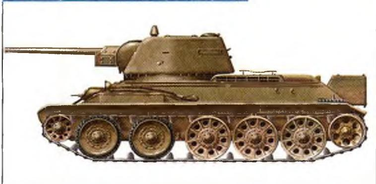
при той же конфигурации была сварной, опорные катки литые с внутренней амортизацией, ребрами жесткости и отверстиями круглого сечения **1**, **2**. Обе машины в передней части правого борта имели кронштейны для крепления ввода радиостанции. Общая масса машины увеличилась с 26,5 до 28,5 т. На боковых
