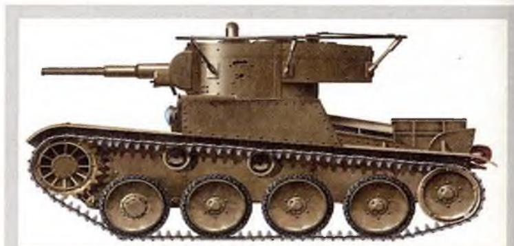
Вооружение и бронирование были аналогичны танку БТ, но боевая масса выше — 15 т. Выпущенная небольшая партия машин отличалась большей сложностью конструкции и меньшей надежностью по сравнению со стоявшими
