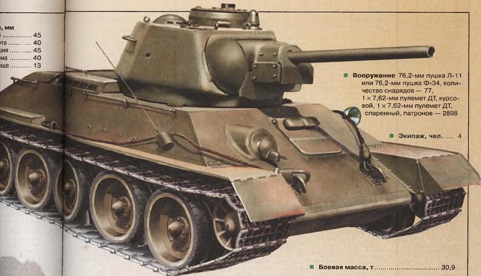
■ **Вооружение** 76,2-мм пушка Л-11 или 76,2-мм пушка Ф-34, количество снарядов — 77, 1 × 7,62-мм пулемет ДТ, курсовой, 1 × 7,62-мм пулемет ДТ, спаренный, патронов — 2898
