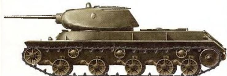
Опытный тяжелый танк ИС-1 с 85-мм гаубицей и добавленным шестым опорным катком
