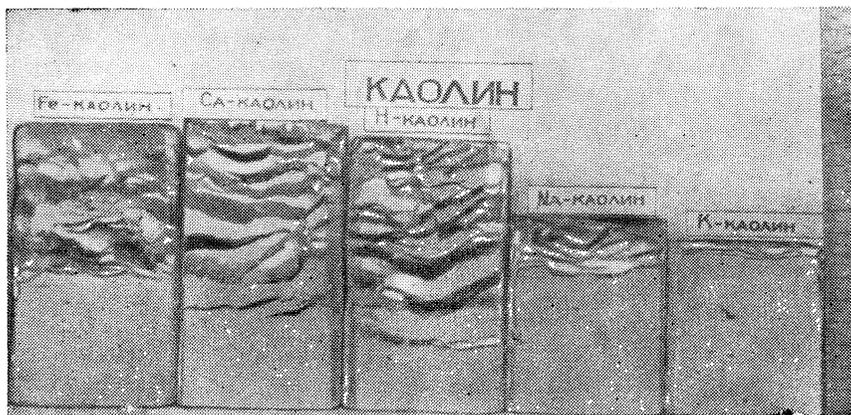
Рис. 27. Образцы каолина с различным составом обменных катионов (после промерзания)
