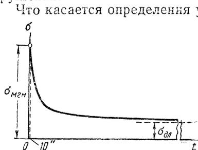
Рис. 62. Кривая длительной прочности мерзлого грунта (по данным испытания шаровым штампом)
