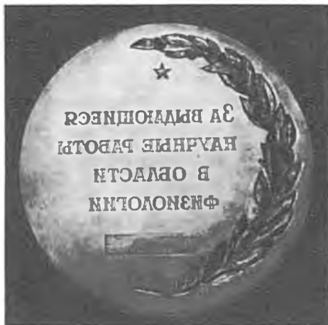
в) медная форма с выворотным текстом, полученным фототравлением;
