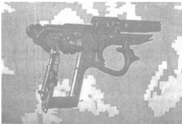
Фото 23. Спусковой механизм справа. Курок взведен
