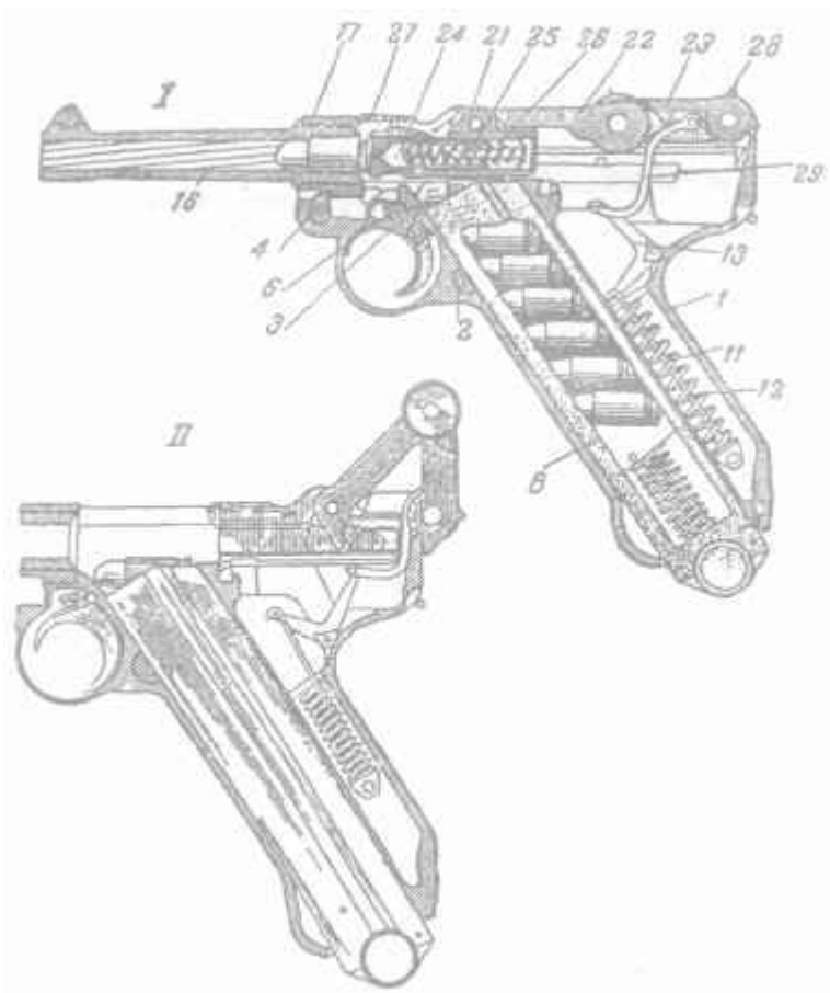
Схема 6. Разрез пистолета по оси:
