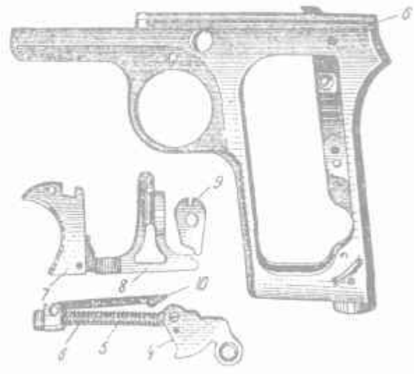
Схема 14. Рамка и детали ударного и спускового механизмов:
