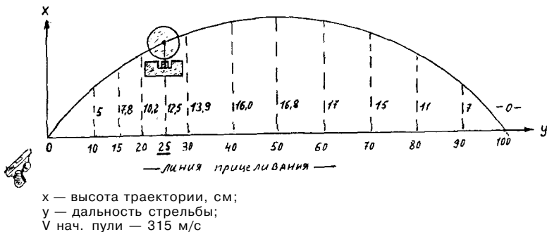
Схема 15. Превышение траектории полета пули пистолета Макарова, пристрелянного с превышением СТП на 12,5 см на дистанции 25 м
