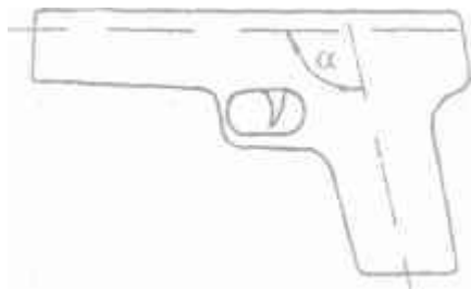
Схема 43. Расположение рукоятки пистолета относительно оси канала ствола
