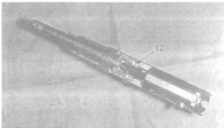
Фото 42. Вырезы 32 в кожухе-затворе для боевых выступов запирающей защелки
