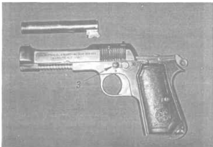
Фото 49. Разборка пистолета: — предохранитель 3 повернуть по часовой стрелке; — отделить затвор «вперед от рамки»
