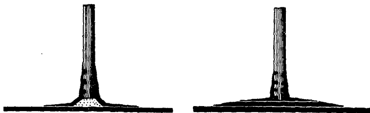
Рис. 136. Виды приформовки внутренних переборок из фанеры.
