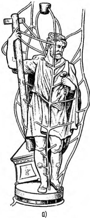
Рис. 97. Формовка по восковой модели:
