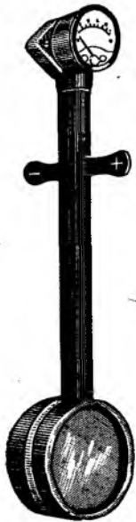
43. Прибор для измерения плотности тока в отдельных участках электролита
