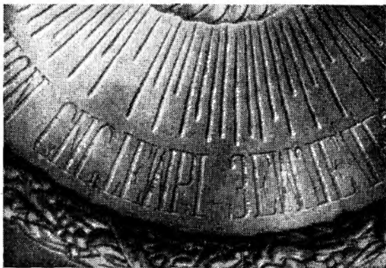
50. Фрагмент медной формы реверса медали. Видны дефекты на буквах
